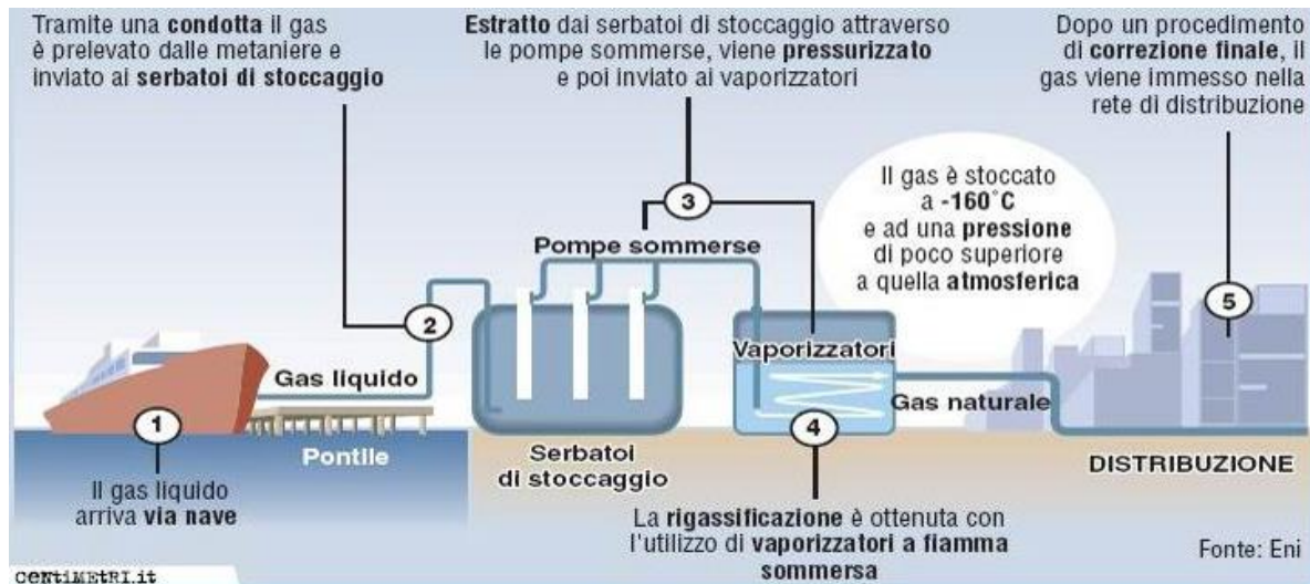
FIGURA 9-4 – SCHEMA FUNZIONALE DI RIGASSIFICATORE
