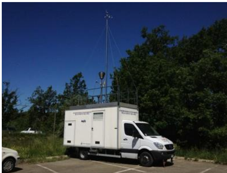
Figura 2.2: Monitoraggio della qualità dell'aria mediante stazione mobile
