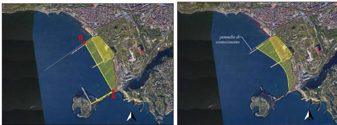
Figura 2.3: Configurazione iniziale della linea di riva (a sinistra) e finale (a destra) risultate dall'applicazione dal modello Genesis (a destra)
