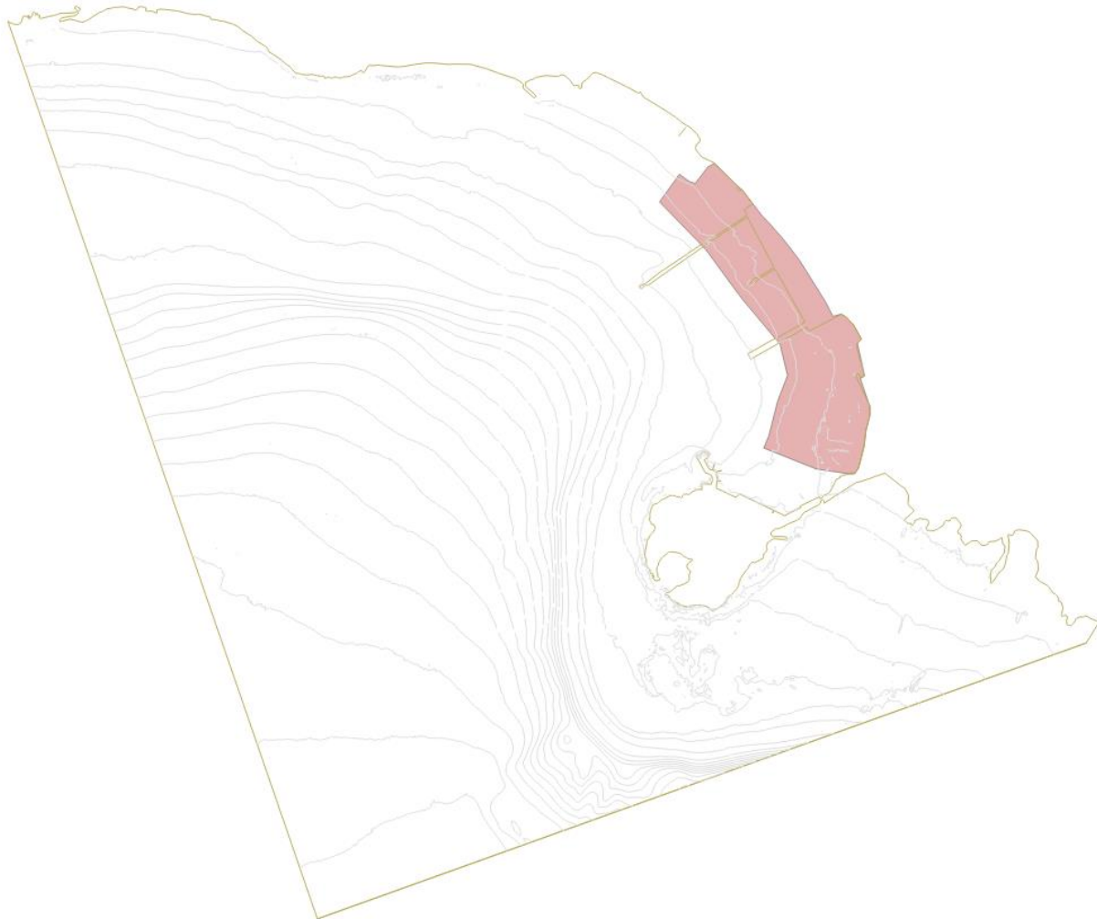
Figura 4.12: Aree di intervento per rimozione e capping
