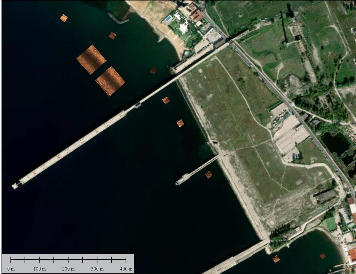
Figura 4.5: Restituzione su base cartografica satellitare del rilievo SSS
