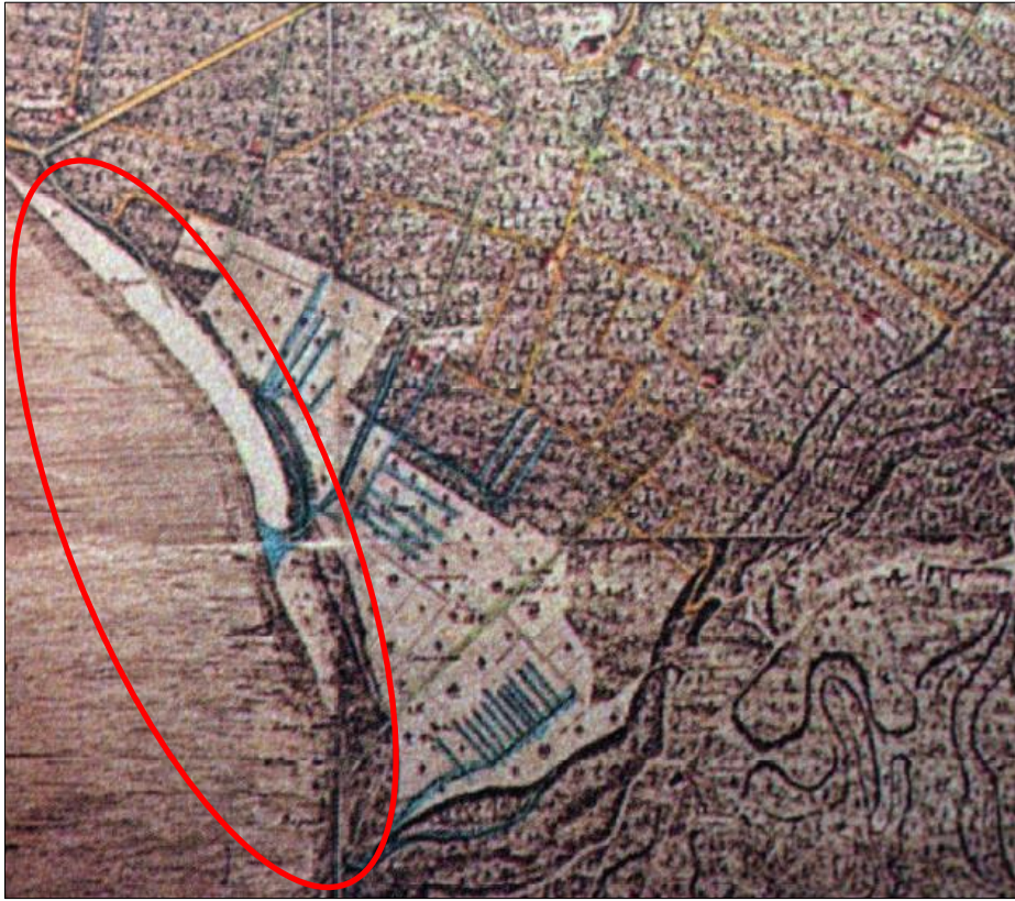
Figura 2.11: La piana di Bagnoli nel 1775 come rilevata dal Duca di Noja. I canali azzurri indicano il sistema di bonifica realizzato in risposta all'impaludamento. In evidenza, la zona in cui ricade l'area di progetto
