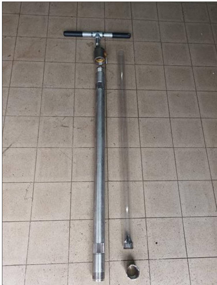
Figura 4.17: Il carotatore manuale utilizzato per il prelievo dei campioni stratigrafici
