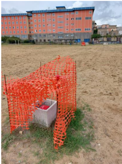
Segnalazione dei piezometri nell'Arenile Nord
