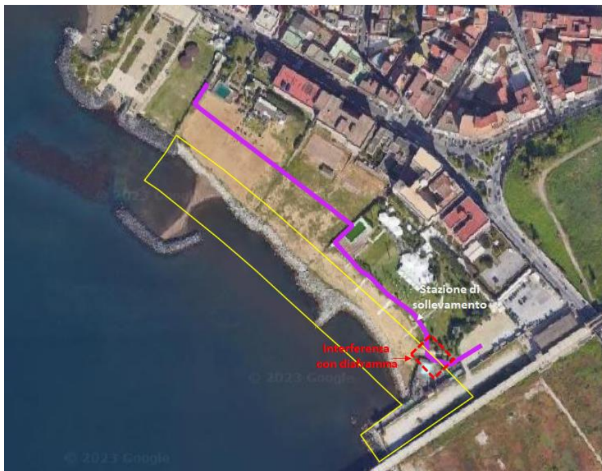
In giallo il confine dell'area di scavo, in magenta il tracciato del diaframma Figura 4.4: Interferenza tra scavo e diaframma Arenile Nord
