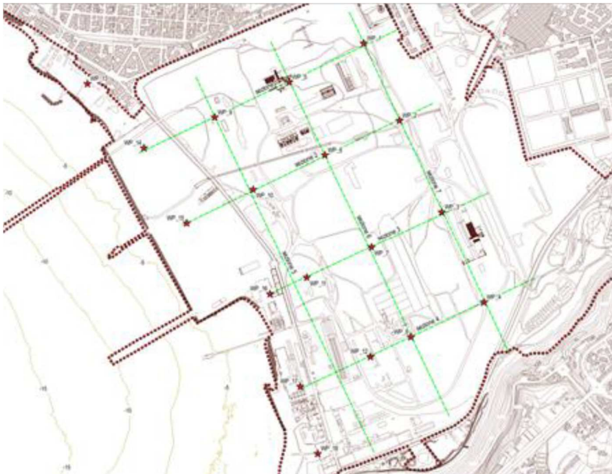
Figura 3.4: Ubicazione dei nuovi sondaggi a carotaggio continuo attrezzati a piezometro
