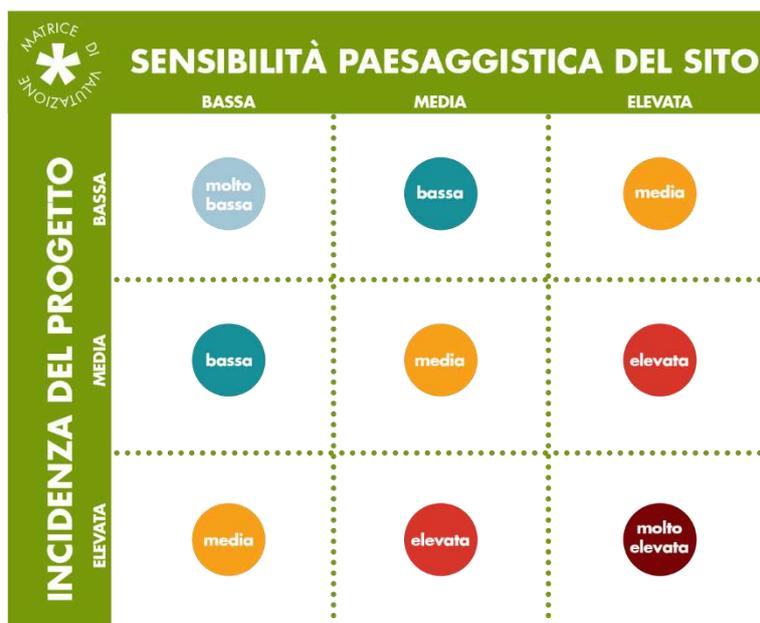
Figura 1.1: Matrice per la determinazione qualitativa sintetica dell'impatto paesaggistico del progetto. (Elaborazione Ambiente)
