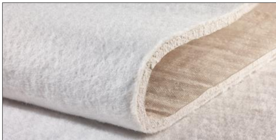
Figura 5.3: Geocomposito filtrante reattivo per metalli
