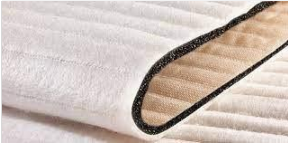
Figura 5.2: Geocomposito filtrante reattivo per composti organici
