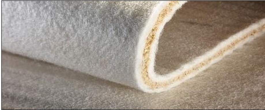
Figura 5.4: Geocomposito filtrante passivo con sabbia
