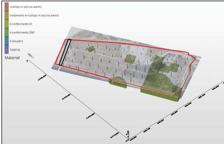
**Figura 2-22: Materiale da inviare a discarica per rifiuti inerti ubicato a nord e sud del pontile**
