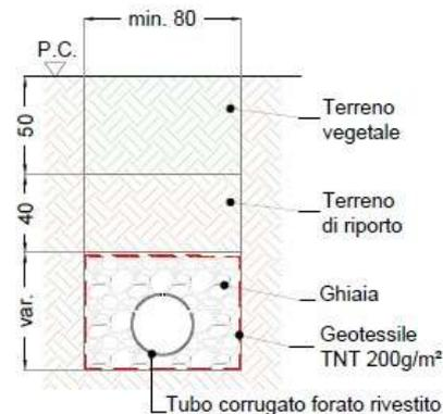
Figura 18 - Stralcio dai particolari costruttivi delle opere di drenaggio superficiale
