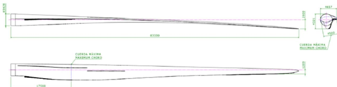
Figura 49 - Tipico Pala (dimensioni in mm)
