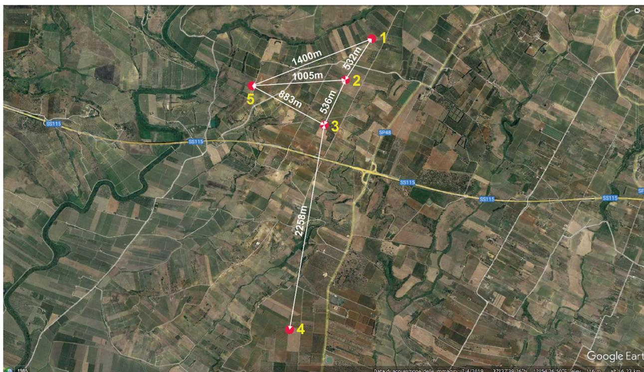
Figura 8 - Distribuzione geometrica degli aerogeneratori del parco eolico con rosa dei venti
