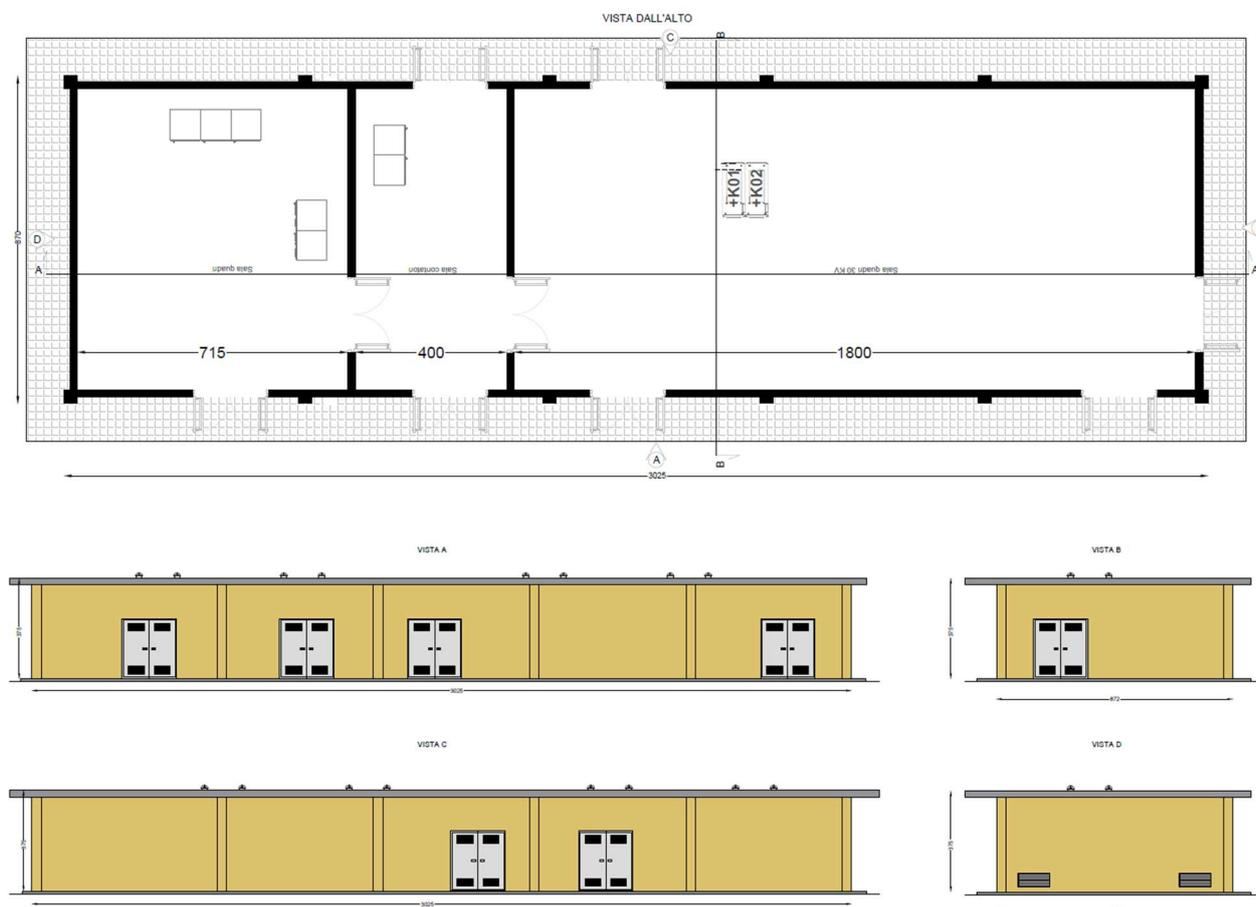
Figura 36 - Planimetria generale e prospetti della cabina BESS
