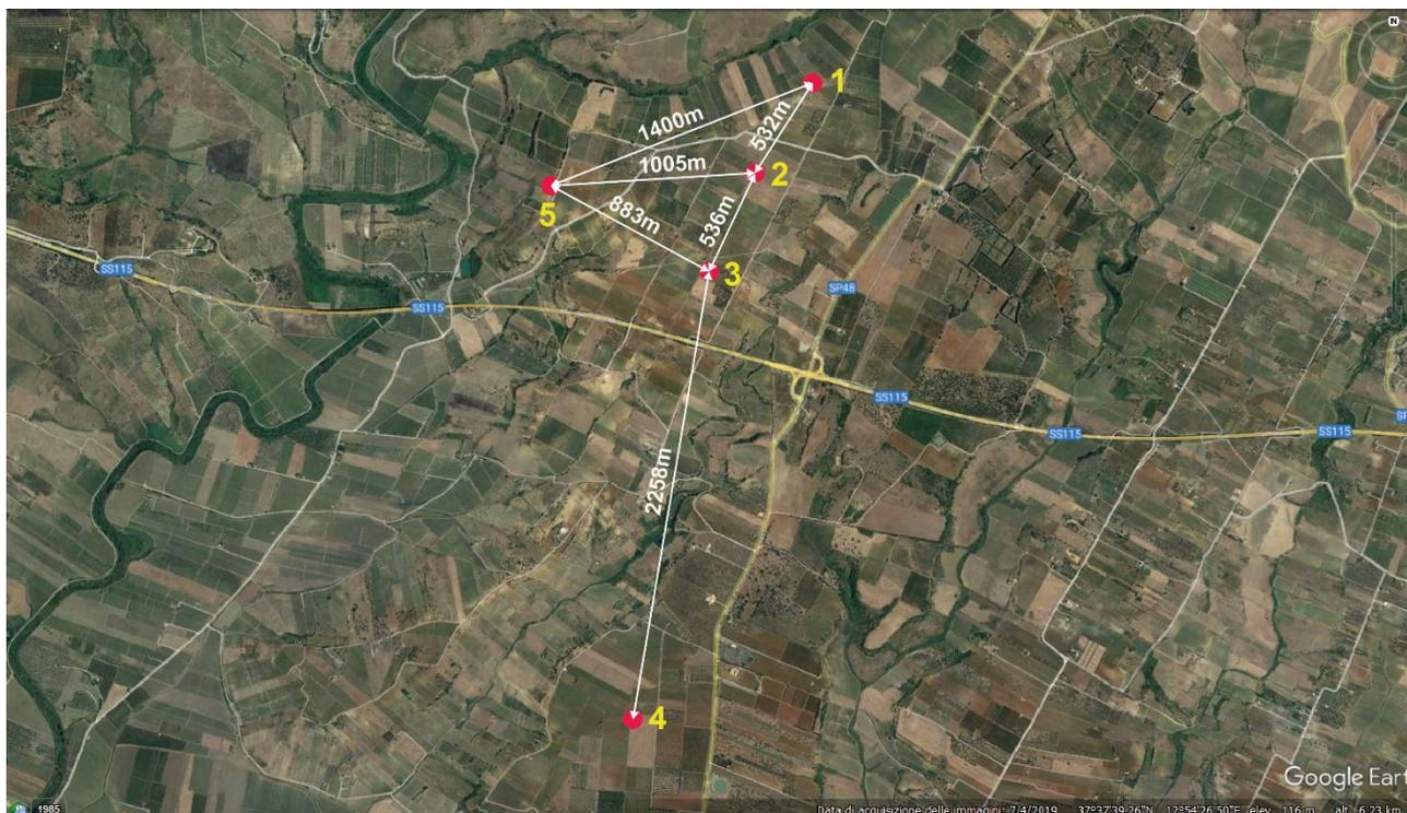
Figura 5 - Distribuzione geometrica degli aerogeneratori del parco eolico
