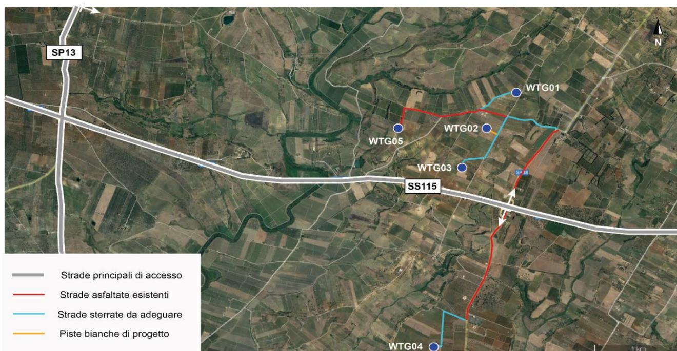
Figura 3 - Viabilità di collegamento tra aerogeneratori
