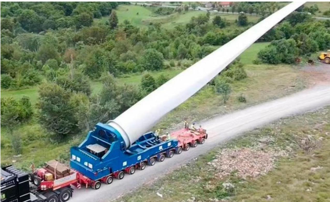
Figura 5 - Blade lifter in funzione durante il trasporto di una pala eolica
