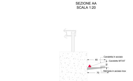
TIPICO RISOLUZIONE INTERFERENZE STRADE - CONDOTTA IN PRESSIONE (INTERFERENZA CON TUBAZIONI DI ACQUEDOTTI - SOTTOSERVIZI VARI) SCALA 1:20
