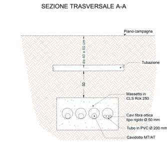
TIPICO DI POSA CON PROTEZIONE IN MASSETTO DI CLS (INTERFERENZA CON CANALE ESISTENTE) SCALA 1:20
