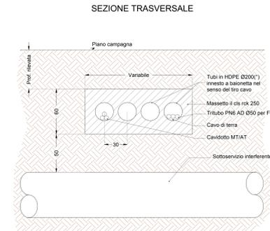
TIPICO DI POSA CON PROTEZIONE IN MASSETTO DI CLS (INTERFERENZA CON TUBAZIONI DI ACQUEDOTTI - SOTTOSERVIZI VARI) SOTTOPASSO SCALA 1:20
