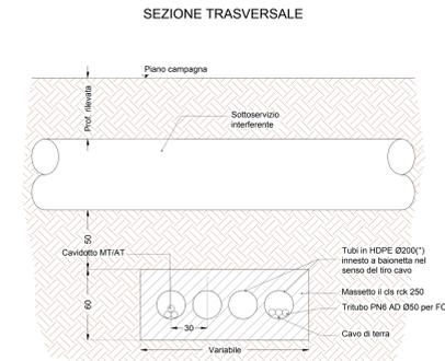
TIPICO DI POSA CON PROTEZIONE IN MASSETTO DI CLS (INTERFERENZA CON TUBAZIONE ESISTENTE) SCALA 1:20
