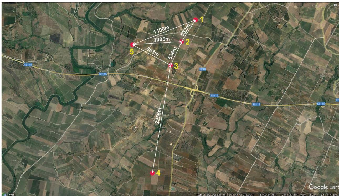
Figura 7 - Distribuzione geometrica degli aerogeneratori del parco eolico
