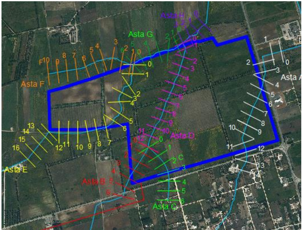
Figura 11 Inquadramento area impianto con indicazione dei reticoli idrografici e delle sezioni trasversali su base ortofoto.
