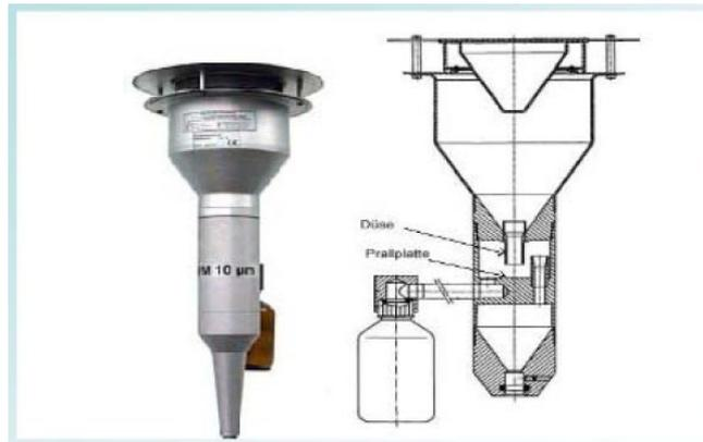
Figura 6 - Testa di campionamento per il prelievo del particolato
