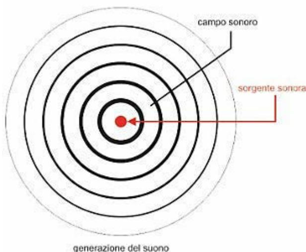
Figura 23 - Schema modalità di propagazione perturbazioni sonore
