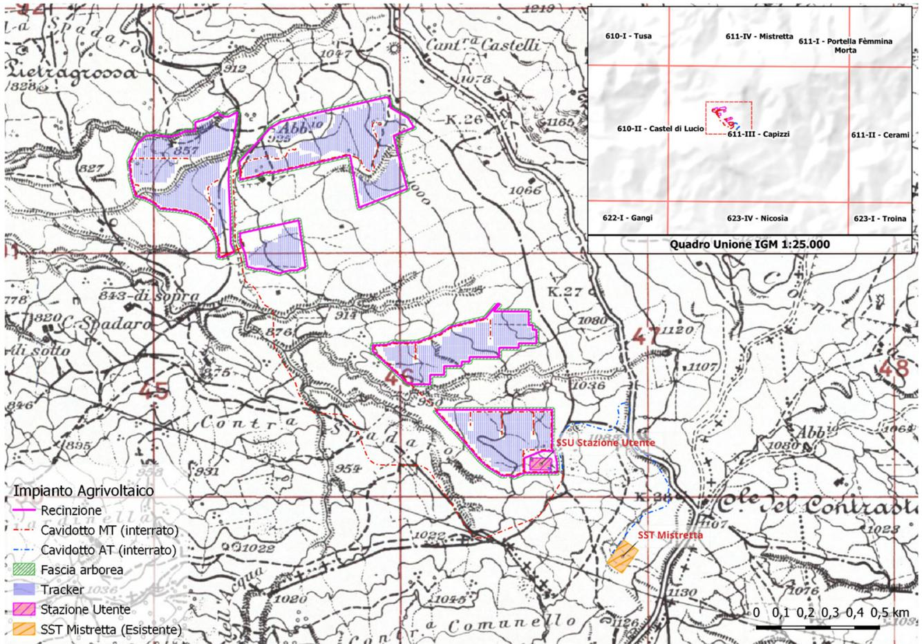
Figura 4 - Inquadramento su IGM 1:25000 – Area impianto e opere di connessione
