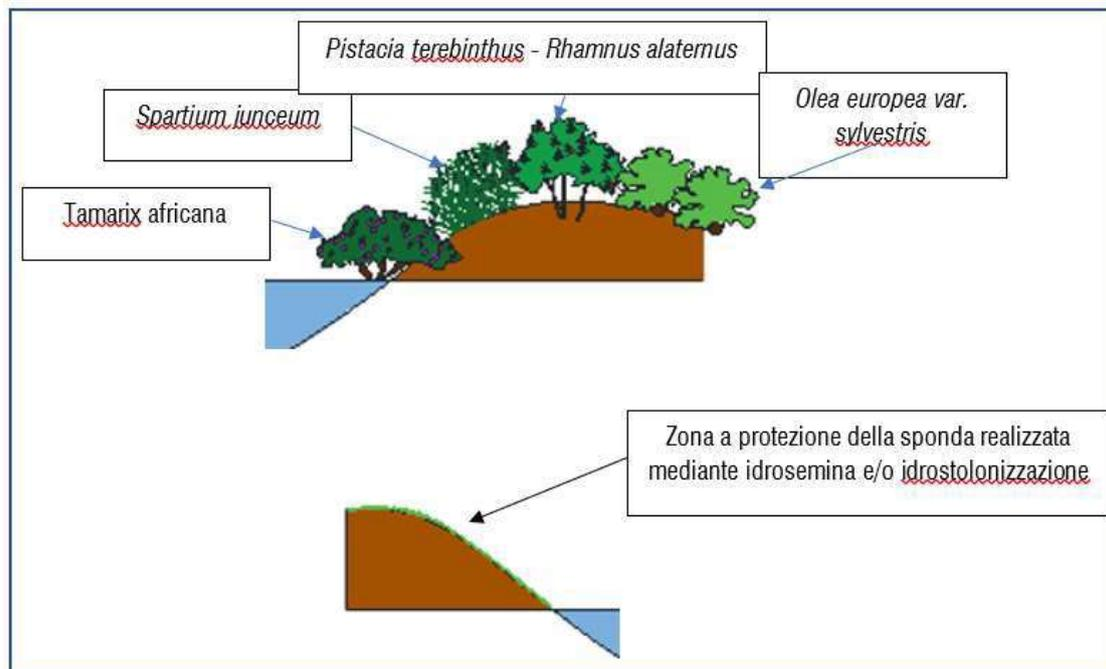
Figura 26 - Sezioni con ipotesi di rinaturalizzazione delle sponde con inerbimenti mediante idrosemina e piantumazione a scalare di essenze arbustive (fascia di 5 m)
