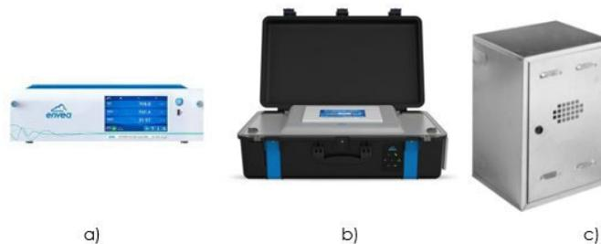
Figura 9 - Stazione mobile per il monitoraggio degli inquinanti da traffico veicolare. a) Misuratore ossidi di azoto a chemiluminescenza; b) Misuratore CO a infrarossi; c) cassetta zincata protezione sonde.
