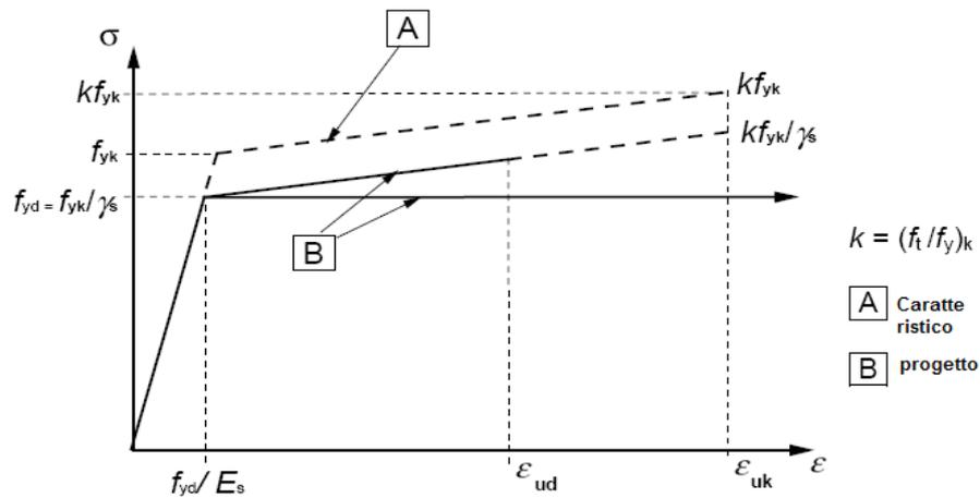
**Legame costitutivo di progetto elastico perfettamente plastico o incrudente a duttilità limitata per l'acciaio.**
