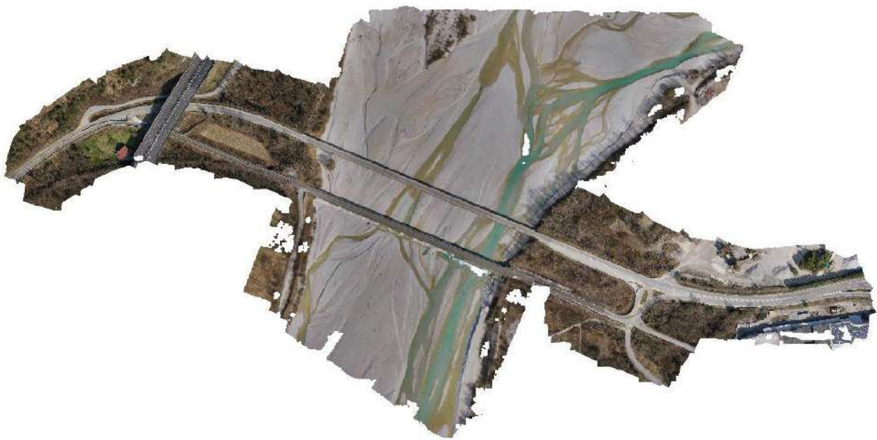
Figura 6.3: Rilievo GPS/celerimetrico passo 2 cm opportunamente georeferenziato.
