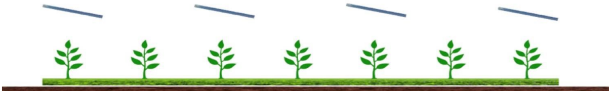
Sistema agrivoltaico in cui la coltivazione avviene tra le file dei moduli fotovoltaici, e sotto a essi (TIPO 1). Fonte: A. Scognamiglio, ENEA
