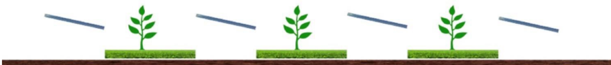
Sistema agrivoltaico in cui la coltivazione avviene tra le file dei moduli fotovoltaici, e non al di sotto di essi (TIPO 2). Fonte: A. Scognamiglio, ENEA
