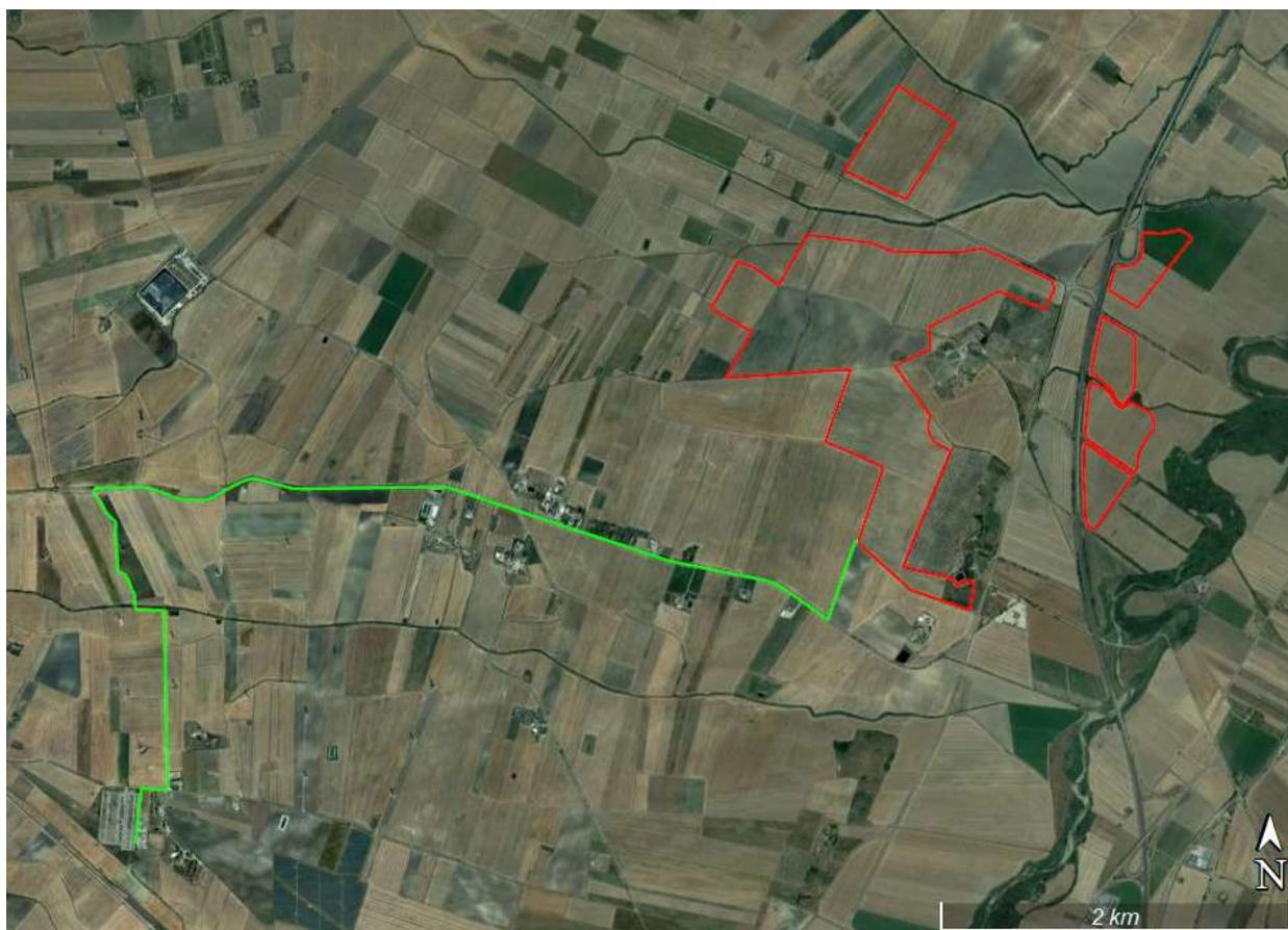
Figura 4.2: In verde il percorso di connessione dal campo FV alla Sottostazione AT 380/150 kV Deliceto.
