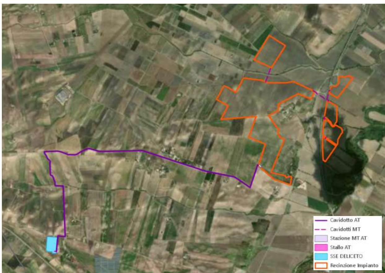
Figura 4.33: Layout impianto fotovoltaico e linea di connessione
