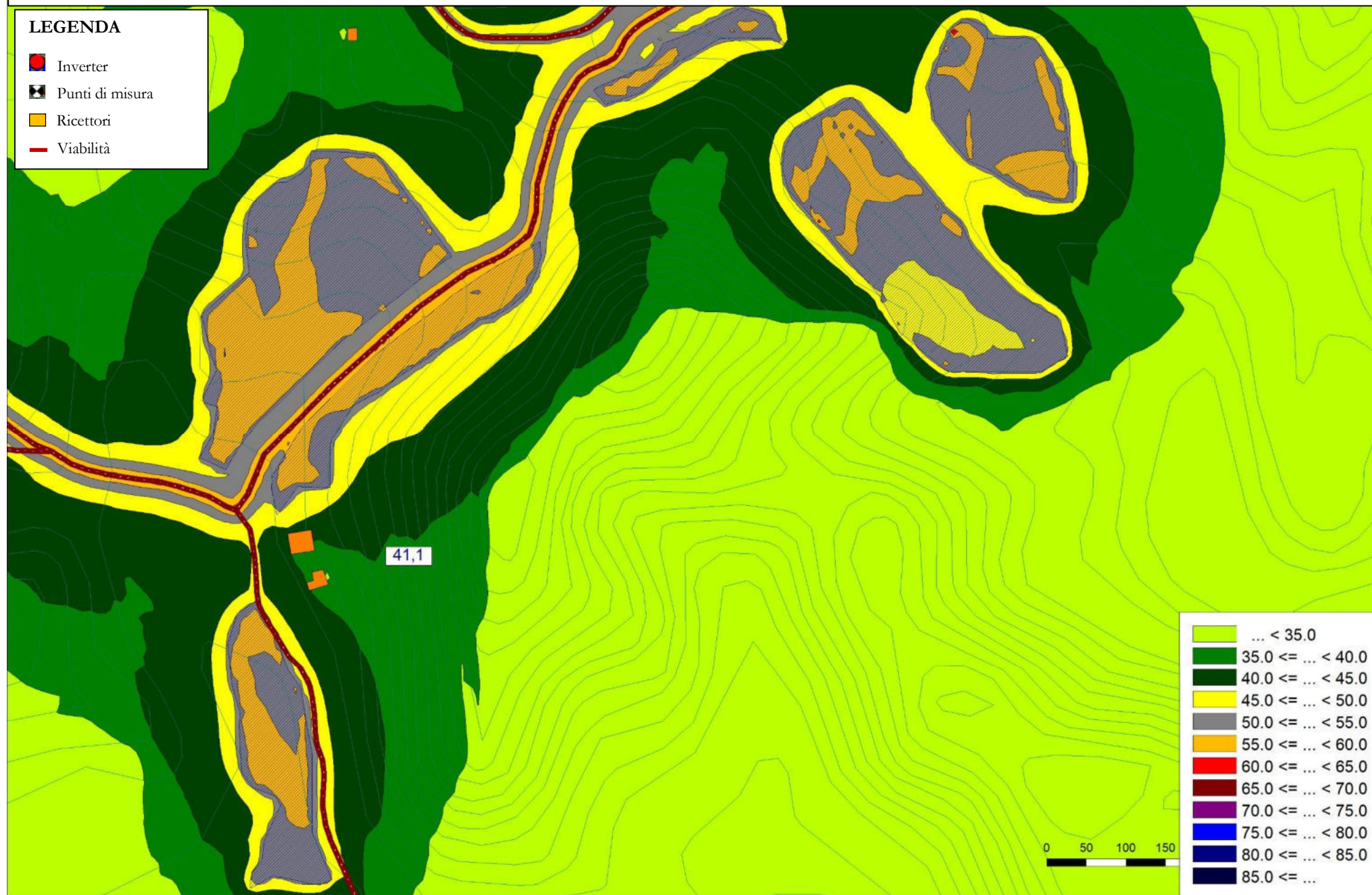
TAVOLA 12 – Mappa dei livelli di Immissione fase cantiere di installazione pannelli (Area Sud)
