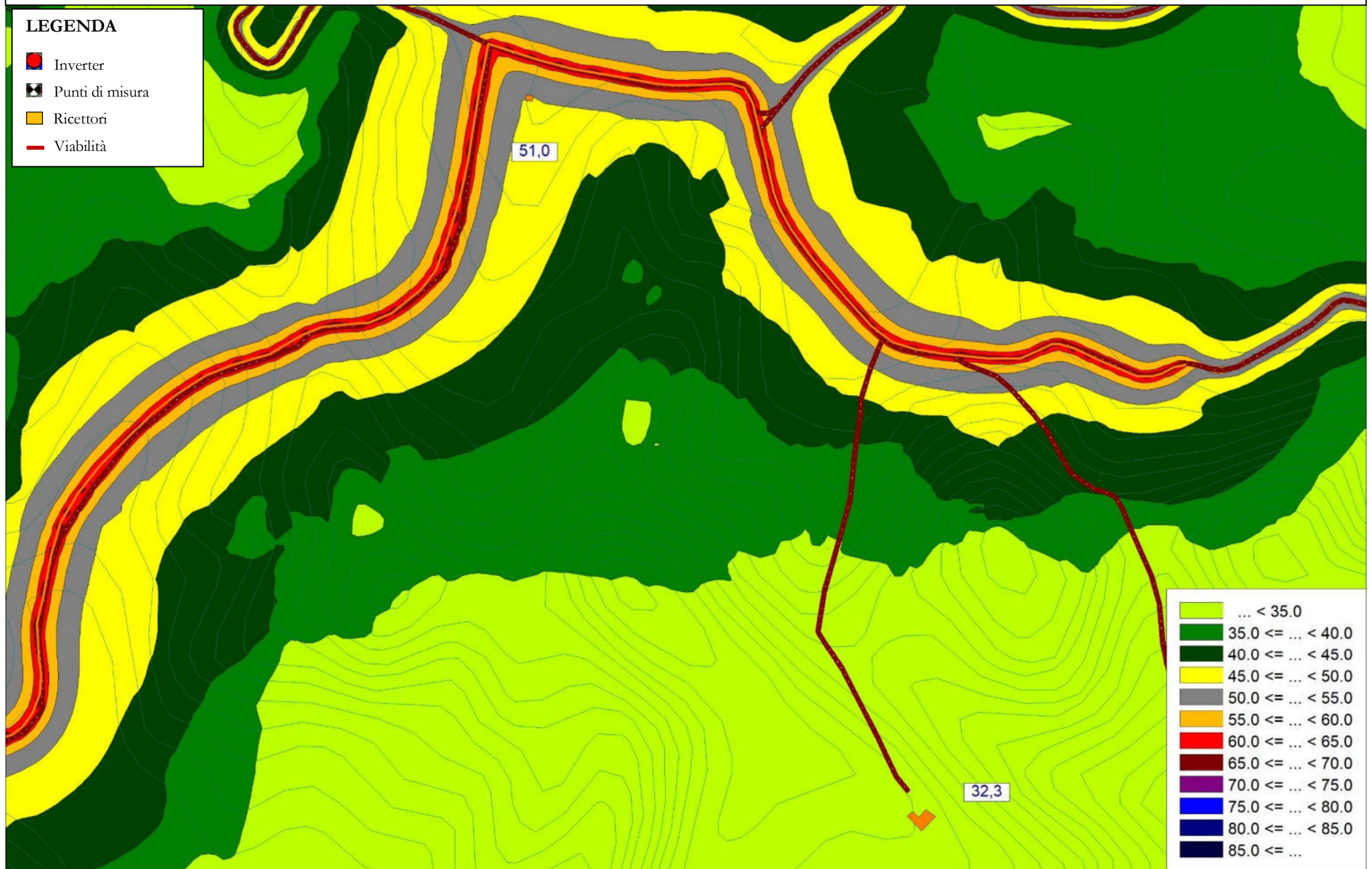
TAVOLA 14 – Mappa dei livelli di Immissione fase cantiere di realizzazione del cavidotto (Area Nord)
