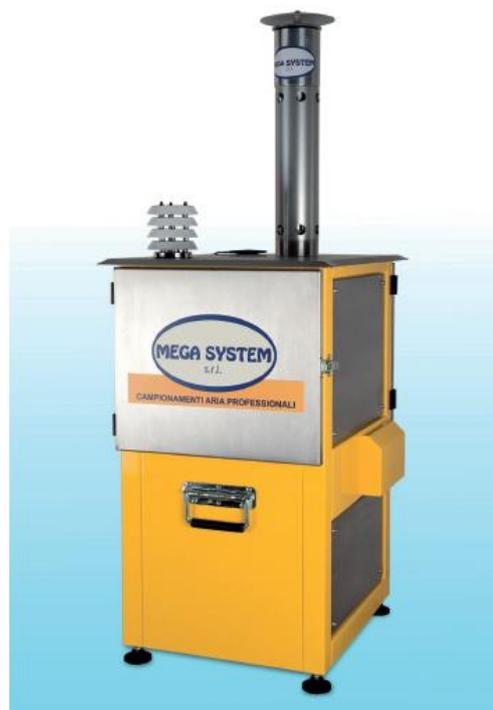
La cabina è dotata di un sistema di condizionamento a Peltier per garantire la conservazione dei filtri campionati ad una temperatura controllata inferiore ai 23 °C (UNI EN 12341:2014 – punto 5.1.8)
