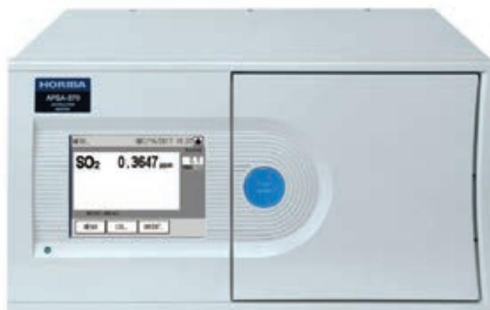
Analizzatore per il monitoraggio ambientale del SO<sub>2</sub> a fluorescenza UV con forno convertitore integrato per la misura alternata del H<sub>2</sub>S. Il modulo APSA-370 è realizzato in accordo alla VDI 4202/4203. Certificato QAL1 TUV secondo la norma EN14212.
