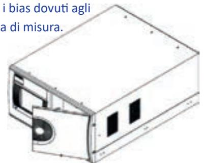
L'analizzatore APNA-370 è dotato di un filtro di protezione in ingresso alla linea di trasporto del campione. L'accesso al vano portafiltro è situato sul pannello frontale per semplificare le operazioni di sostituzione del filtro stesso. L'elemento filtrante è unico e comune a tutti gli analizzatori della serie AP-370.
