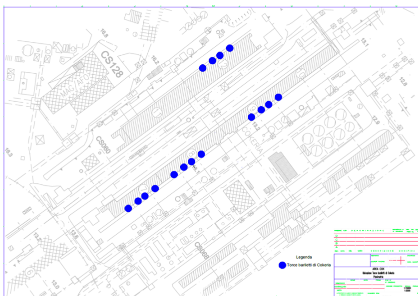
Figura 1. Ubicazione delle torce bariletti di cokeria alle batterie attualmente funzionanti (batt. 7-8-9-12)
