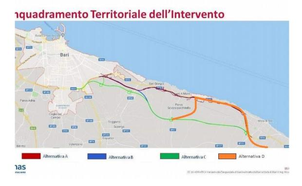
In arancione la proposta, quale soluzione D), che prevede il semi anello di chiusura della variante a nord/sud di Torre a mare (in base alla direzione di marcia) e la realizzazione di una terza corsia (per ognuna delle direzioni di marcia) sull'attuale tracciato stradale tra Torre a Mare e Mola (e viceversa), con prolungamento fino all'attuale svincolo di Cozze-Conversano. L'indicazione del tracciato è esemplificativa: andrà calibrata nel reale percorso dagli organismi tecnici.
