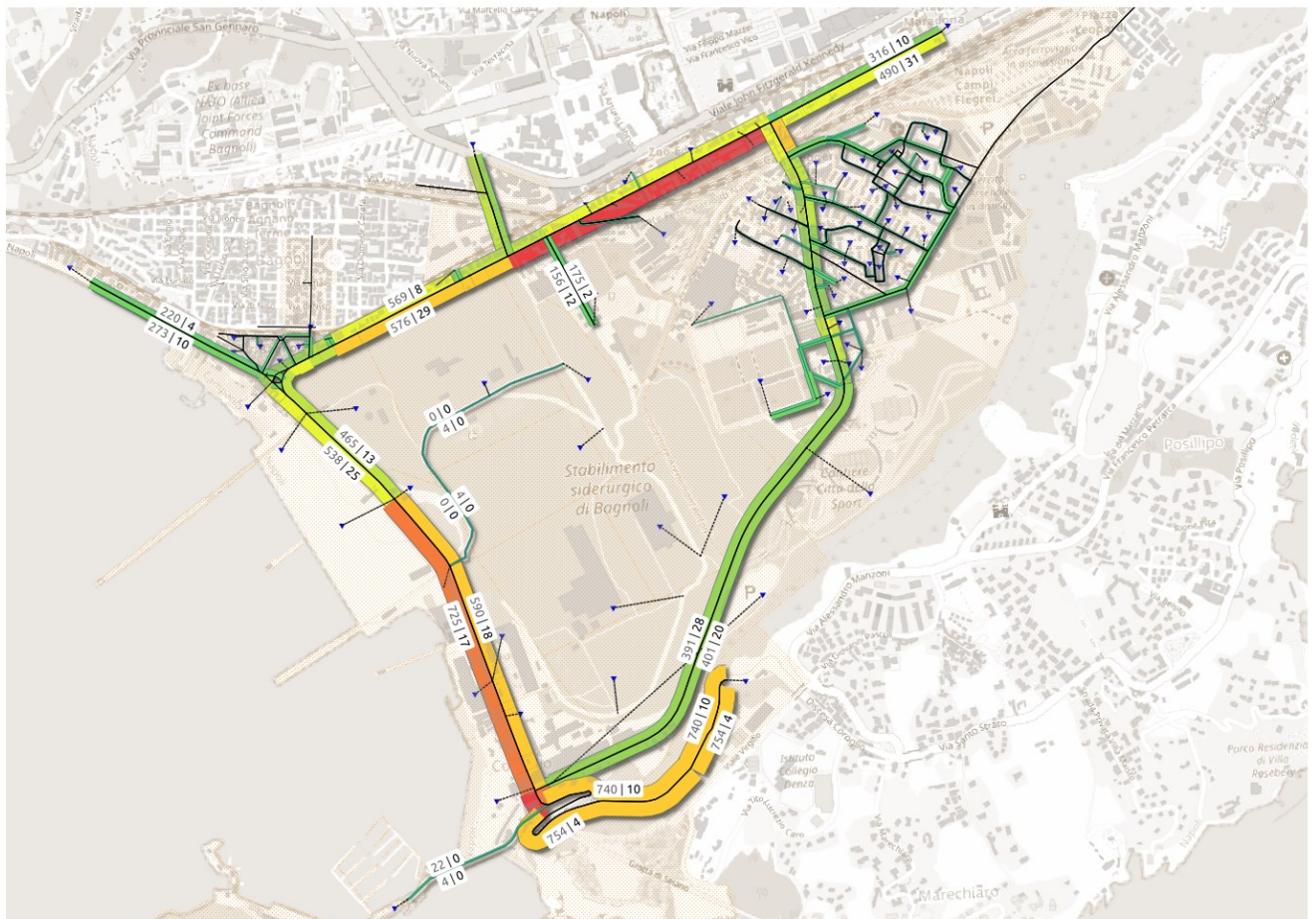
Figura 3.1 - Flussogramma saturazione allo stato attuale
