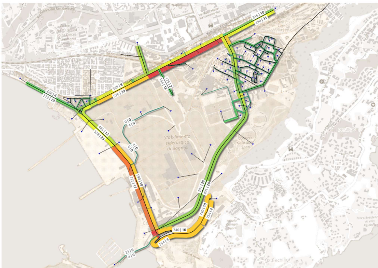
Figura 7-4 - Flussogramma saturazione allo stato attuale
