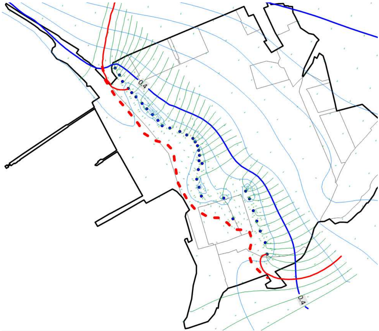
Figura 5-4 – Freatimetria 3° Layer (-15 mslm) con pathlines – la linea rossa tratteggiata rappresenta la massima estensione dei punti di stagnazione – la linea rossa continua rappresenta la pathlines più esterna che racchiude la fascia di cattura del barrieramento.
