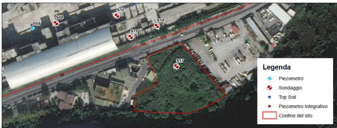
Figura 2-8: ubicazione indagini eseguite
