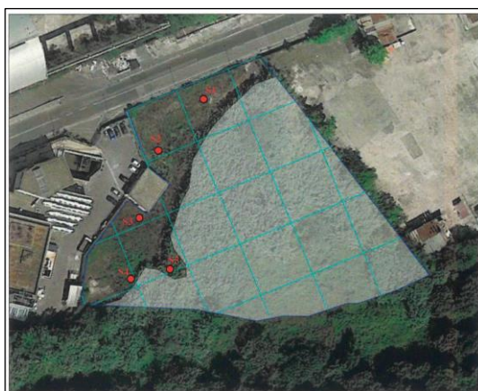
Figura 2-9: ubicazione indagini eseguite
