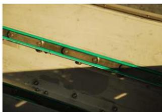
Sgrigliatore a 2 o 4 pettini in profilato di acciaio inox Aisi 304 e pettine raschiante in Polizene a profilo dentato su due lati e quindi intercambiabile, montato sulle catene di trascinamento. In caso di incagliamento a causa di un sasso, il dente in polizene si romperà senza bloccare pettine e macchina. In questo modo il lavoro sarà assicurato senza allarmi notturni. Macchina con contropettine pulitore.
