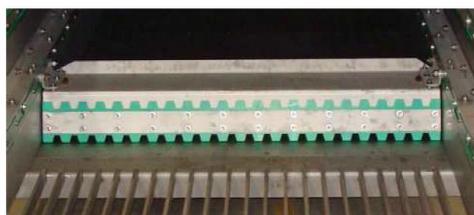
Lo sgrigliatore è provvisto di un sistema di tensionamento automatico delle catene, per compensare i piccoli allungamenti e le oscillazioni fisiologiche prodotto dalla rotazione.
