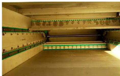
Impianto di grasso per la lubrificazione delle parti mediante pompa manuale con attacco universale.
