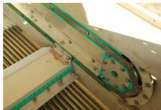
Catene di trascinamento in acciaio inox Aisi 304 a rulli FV 112 – C120 (carico di rottura 120 kN), piatti 40 mm x 6 mm, perni diametro 16 mm, rulli diametro 32 mm (tipo B), passo 160 mm adatte per il servizio continuativo in condizioni particolarmente gravose. Le catene scorrono lungo un binario in Polizene senza possibilità di spostamenti laterali della catena e riducendo al minimo eventuali sbilanciamenti della stessa.
