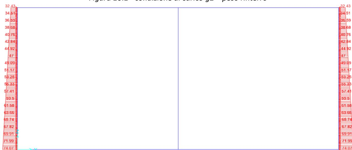
Figura 10.2 - condizione di carico g1 – spinta del terreno
