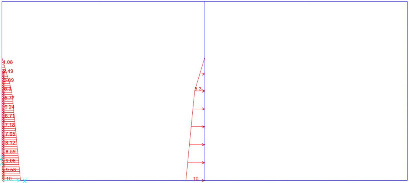
Figura 10.5 - condizione di carico  $u_{din}$  – spinta idrodinamica dell'acqua vasca sinistra
