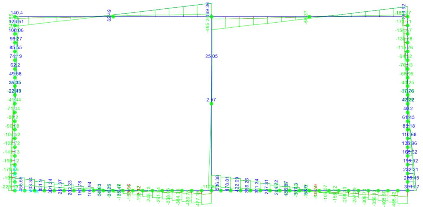
Figura 10.16 - Involuppo SLV sforzo di taglio
