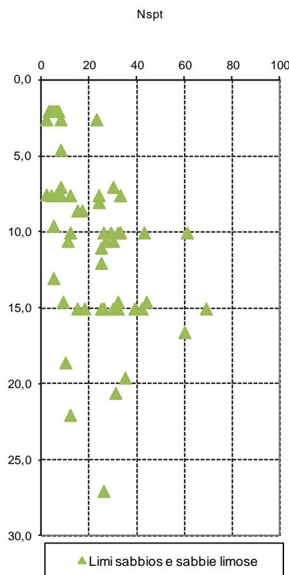
Figura 5.3 – valori penetrometrici SPT nei limi sabbiosi
