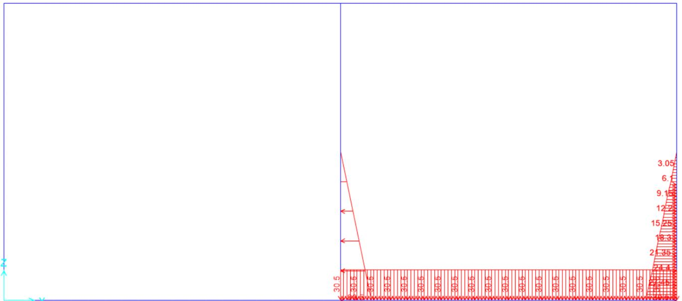
Figura 10.4 - condizione di carico u – spinta statica dell'acqua vasca destra
