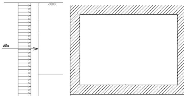
Fig. 9 – Schema per il calcolo degli effetti della sovrappinta sismica del terreno
