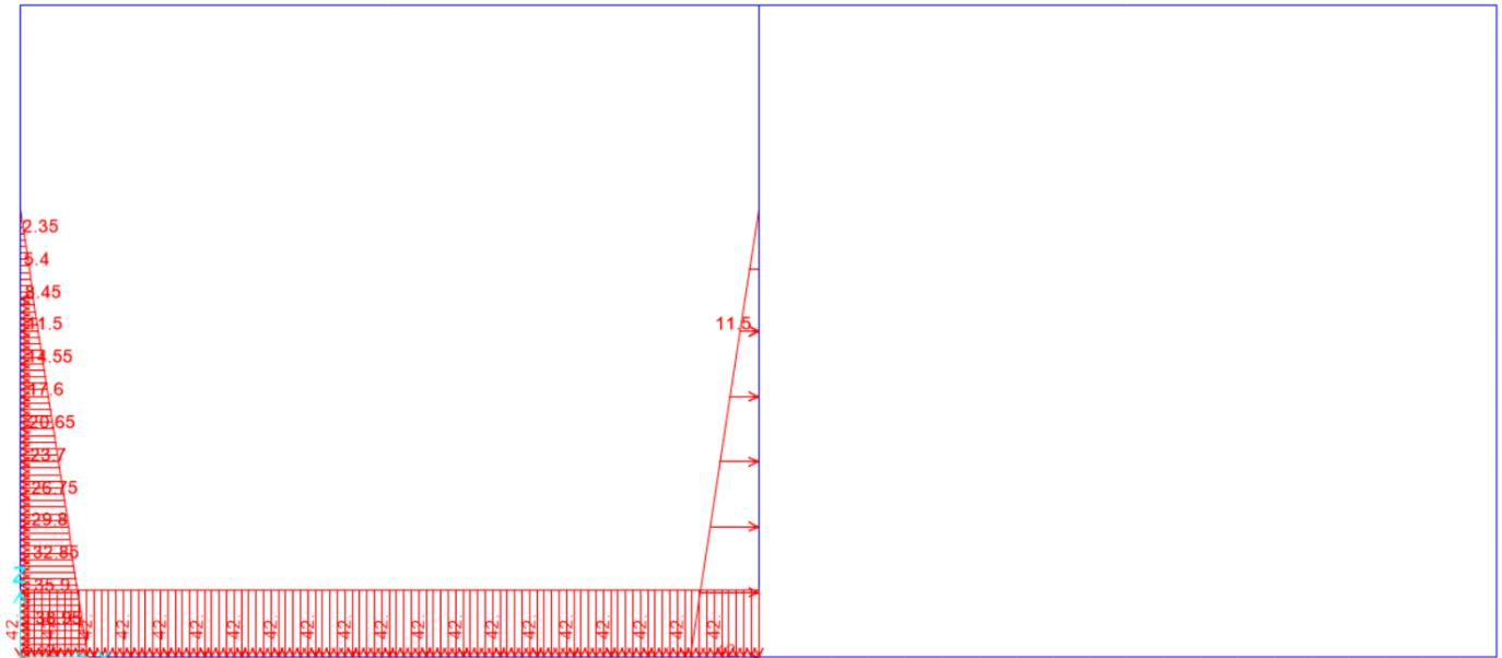
Figura 10.3 - condizione di carico u – spinta statica dell'acqua vasca sinistra
