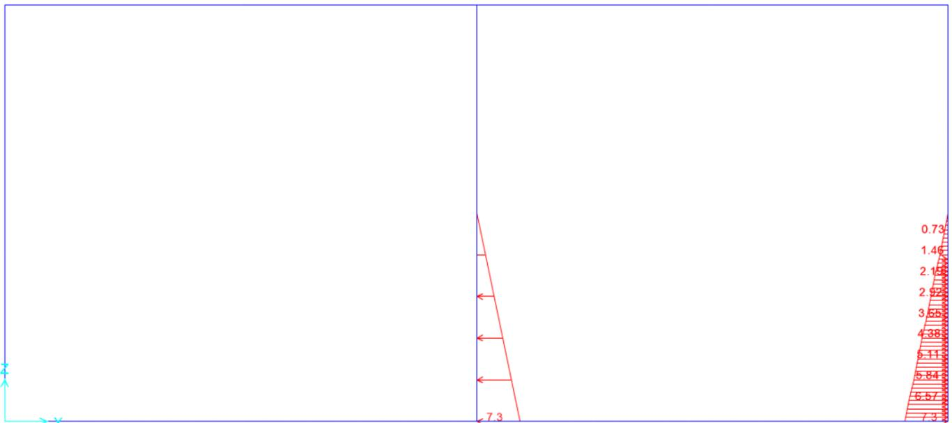
Figura 10.6 - condizione di carico  $u_{din}$  – spinta idrodinamica dell'acqua vasca sinistra
