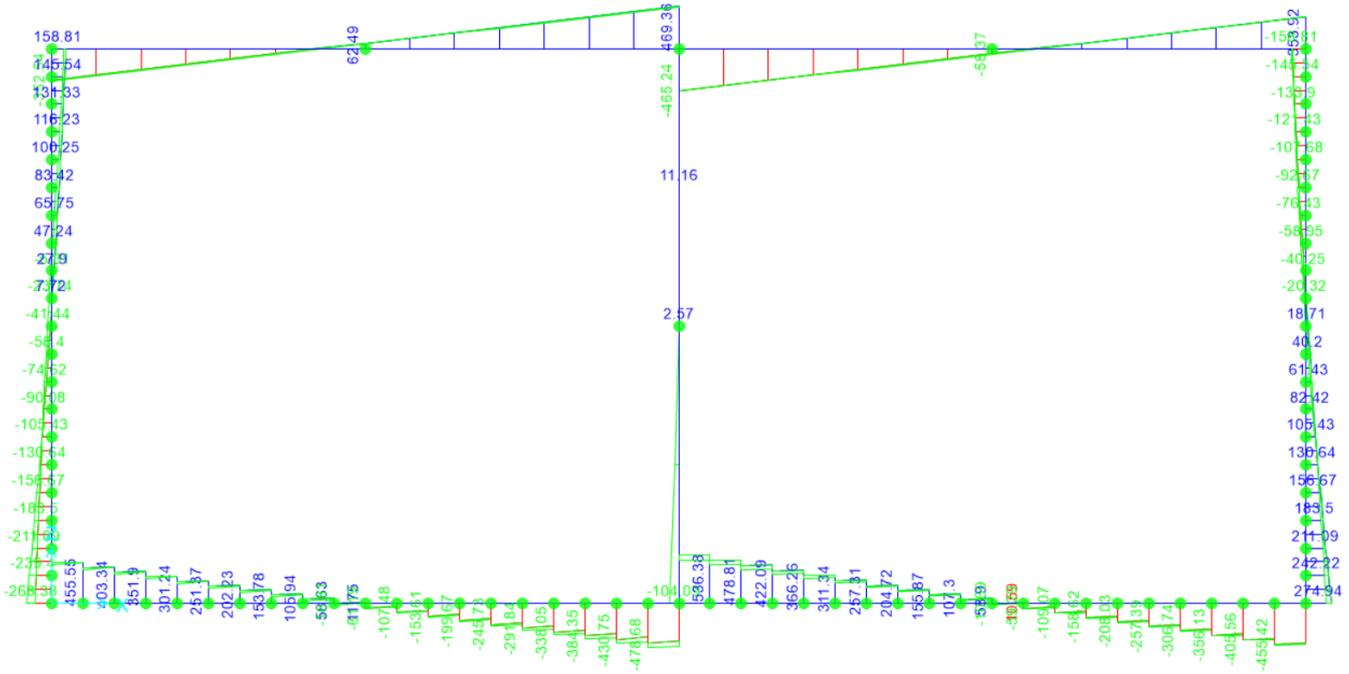
Figura 10.13 – Inviluppo SLU sforzo di taglio
