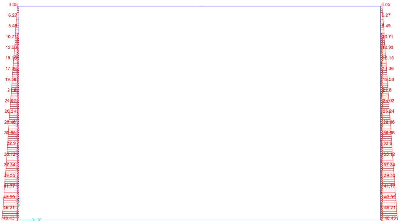
Figura 10.3 - condizione di carico g_1 – spinta del terreno
