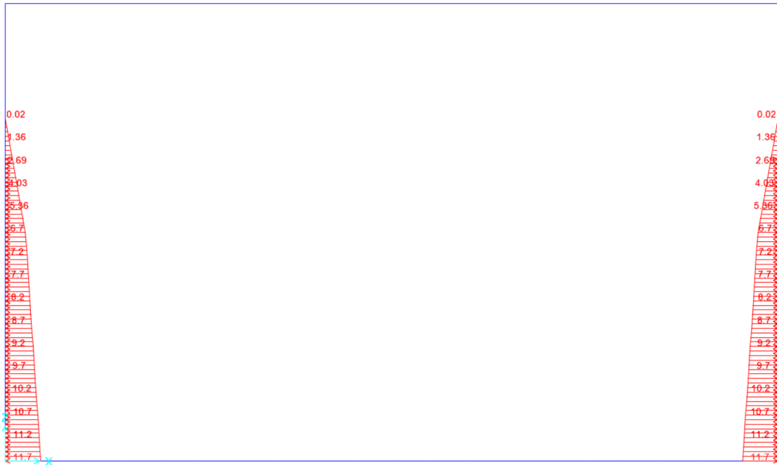
Figura 10.7 - condizione di carico u_{din} – spinta idrodinamica dell'acqua vasca sinistra
