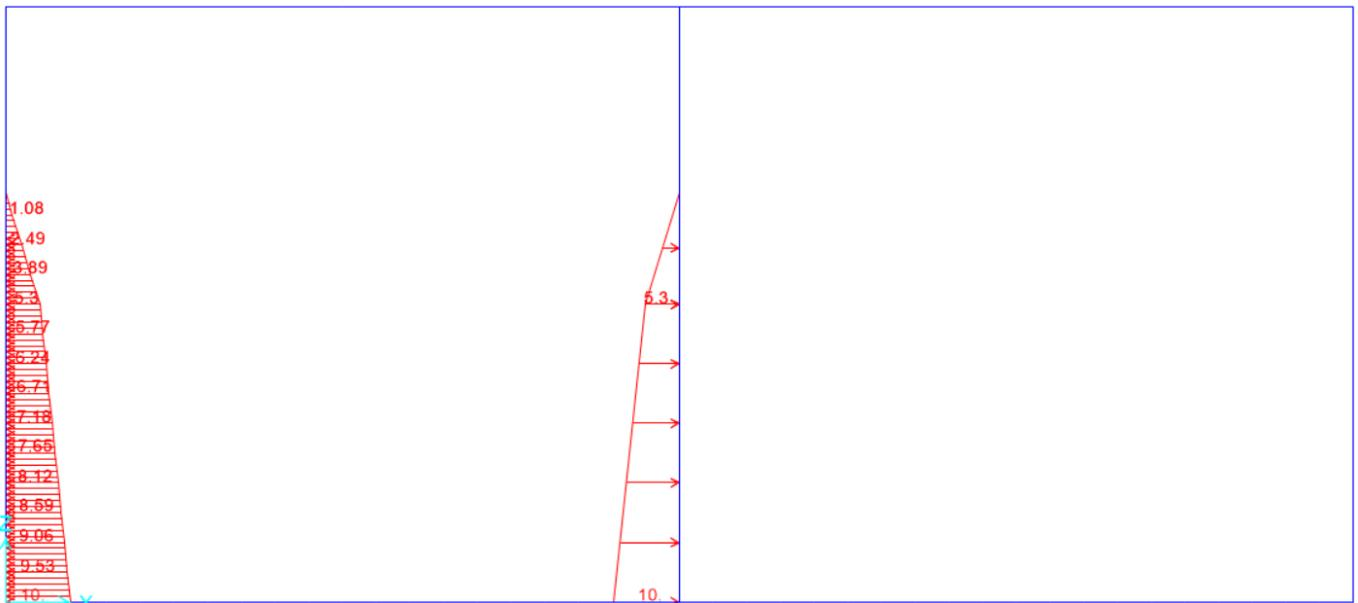
Figura 10.8 - condizione di carico  $u_{din}$  – spinta idrodinamica dell’acqua vasca sinistra
