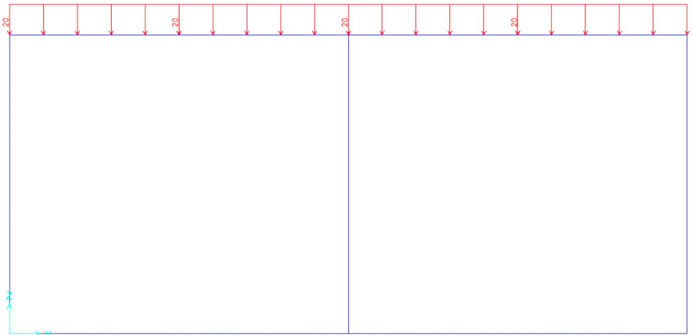
Figura 10.4 - condizione di carico  $q$  – sovraccarico stradale
