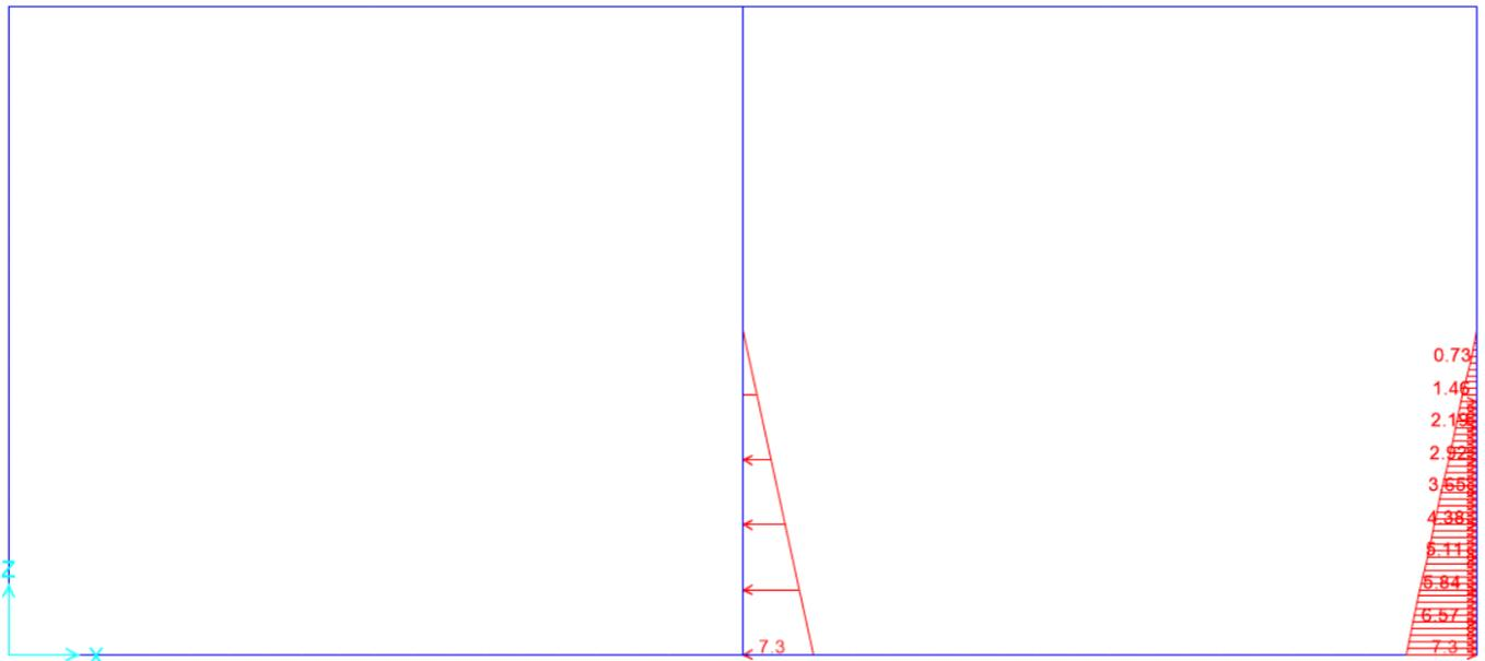
Figura 10.9 - condizione di carico udin – spinta idrodinamica dell’acqua vasca destra
