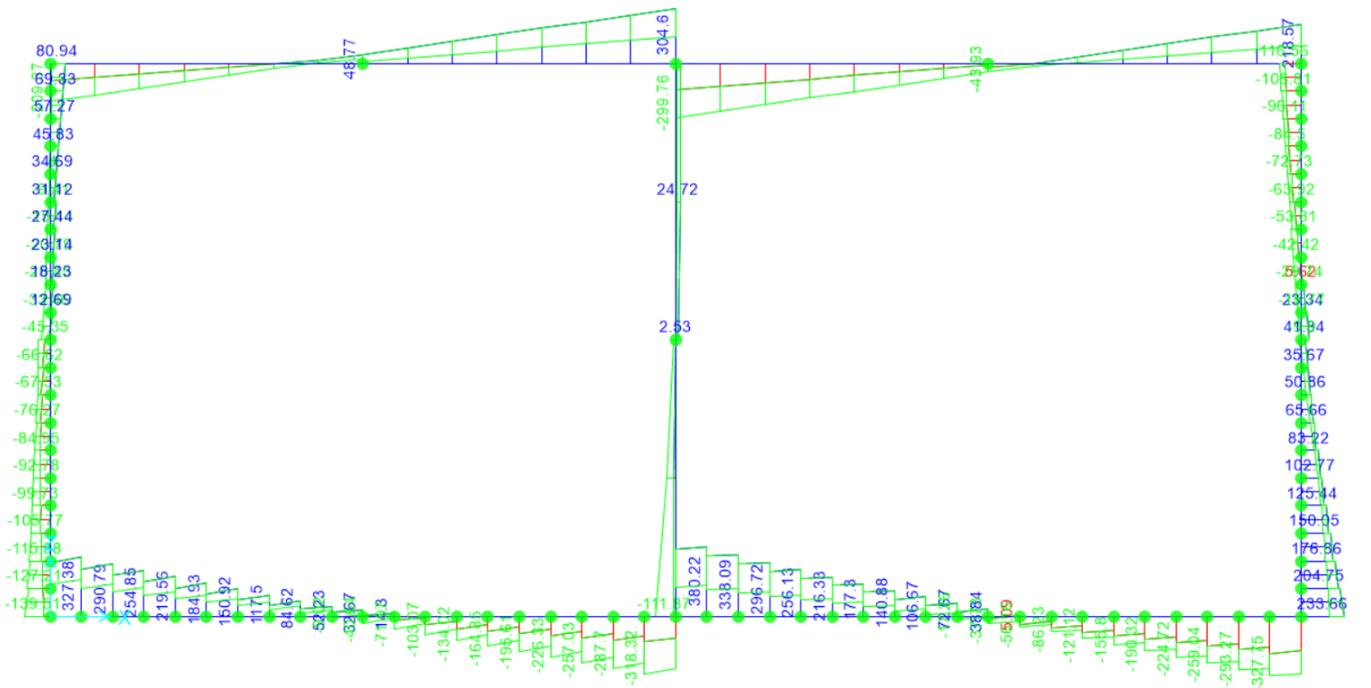
Figura 10.19 - Inviluppo SLV sforzo di taglio
