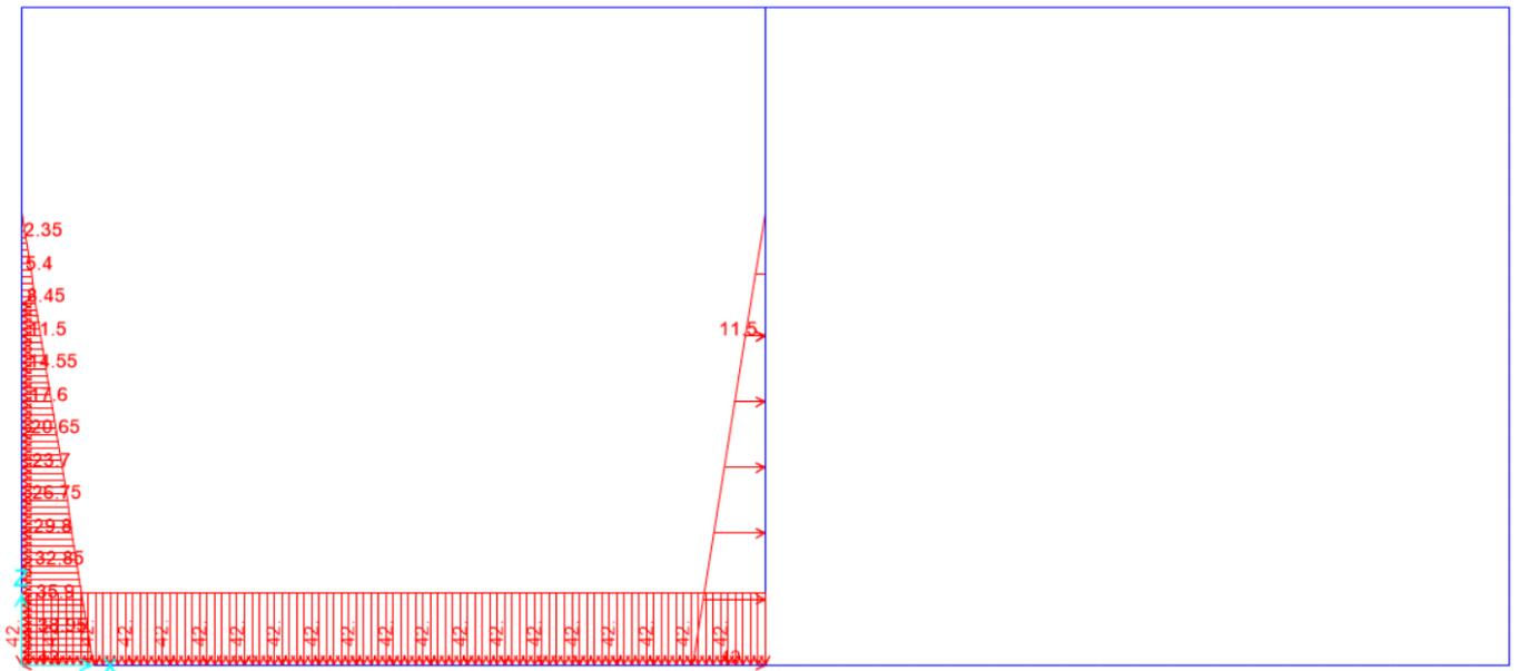
Figura 10.6 - condizione di carico  $u$  – spinta statica dell'acqua vasca sinistra
