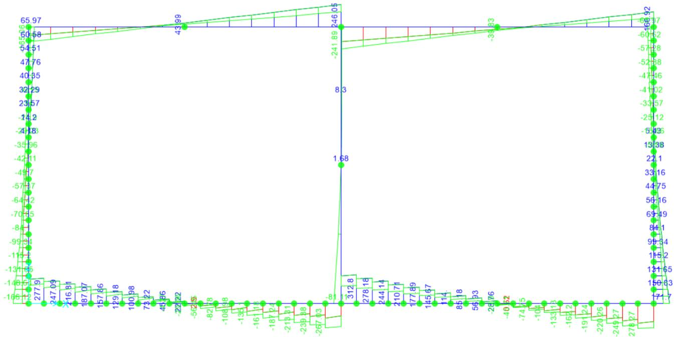
Figura 10.13 – Inviluppo SLE sforzo di taglio
