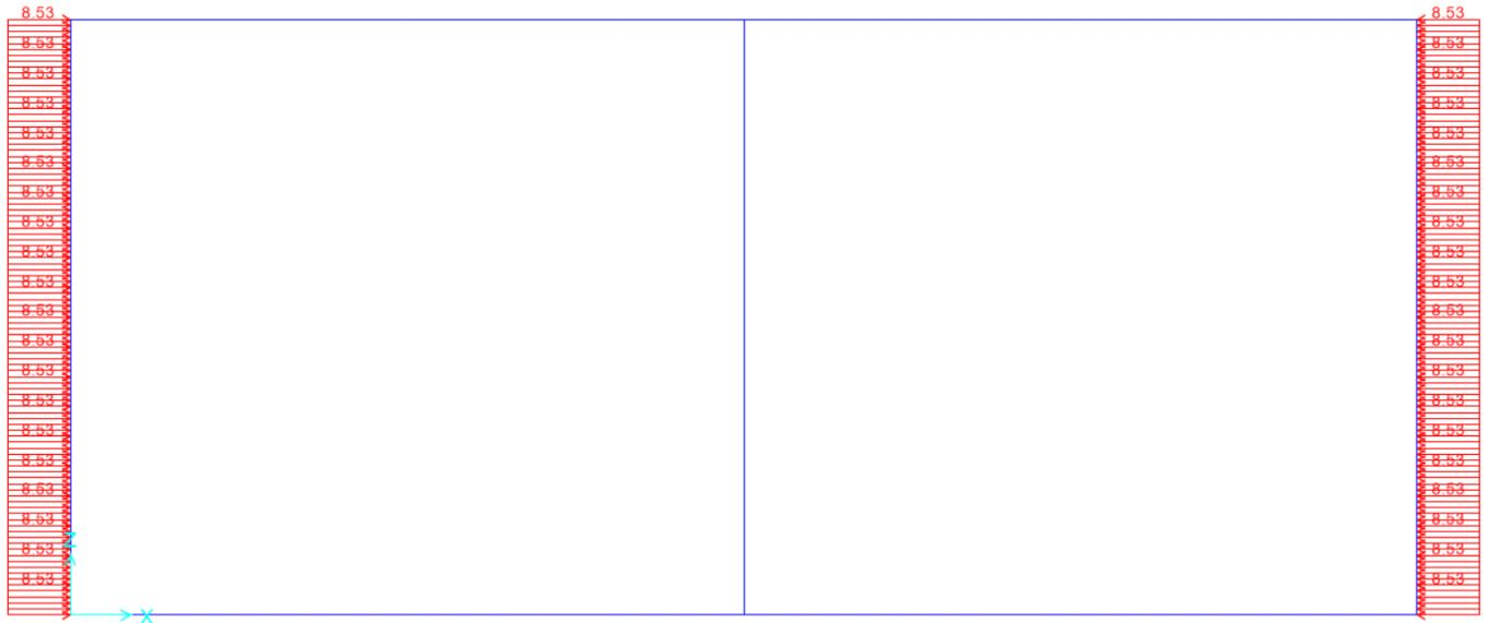
Figura 10.5 - condizione di carico  $q$  – spinta da sovraccarico
