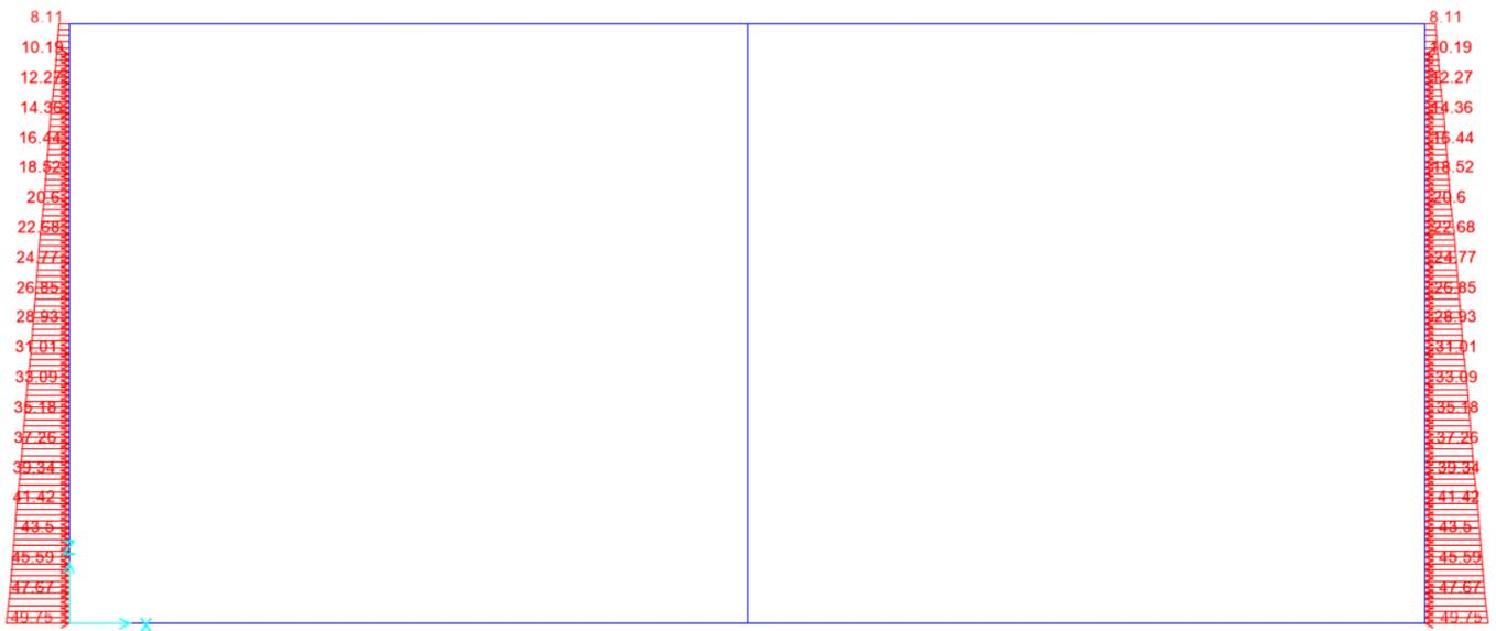
Figura 10.3 - condizione di carico  $g_1$  – spinta del terreno
