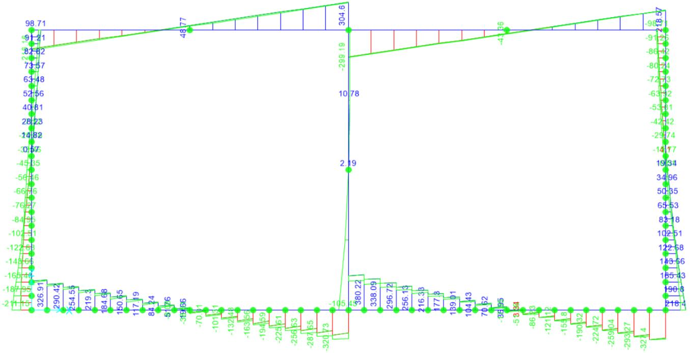
Figura 10.16 – Involuppo SLU sforzo di taglio
