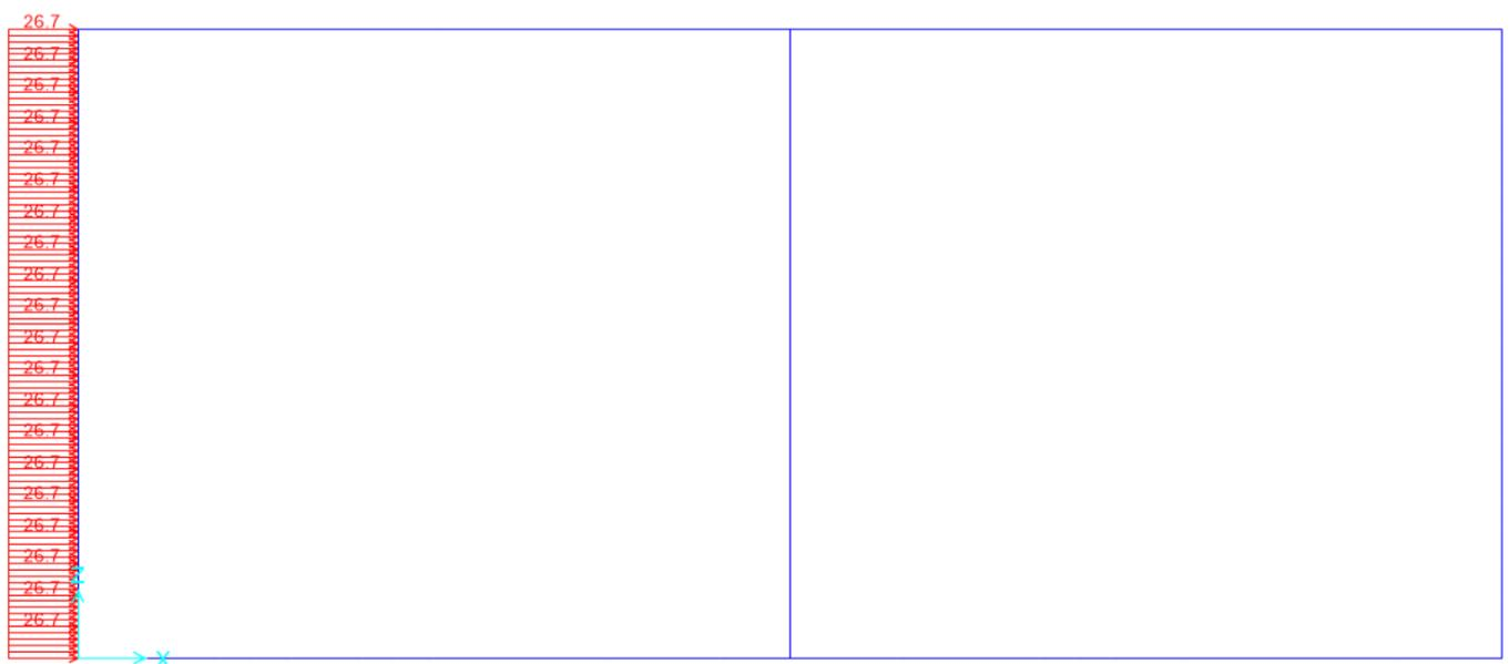
Figura 10.10 - condizione di carico Wood – sovrappinta sismica del terreno
