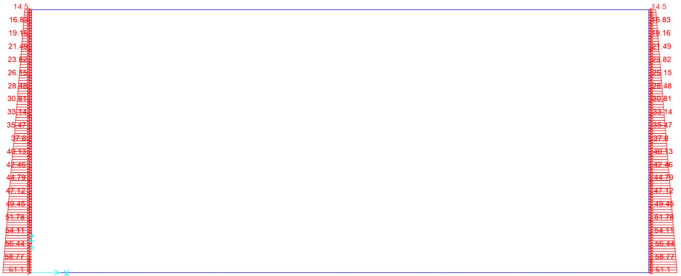
Figura 10.3 - condizione di carico g1 – spinta del terreno
