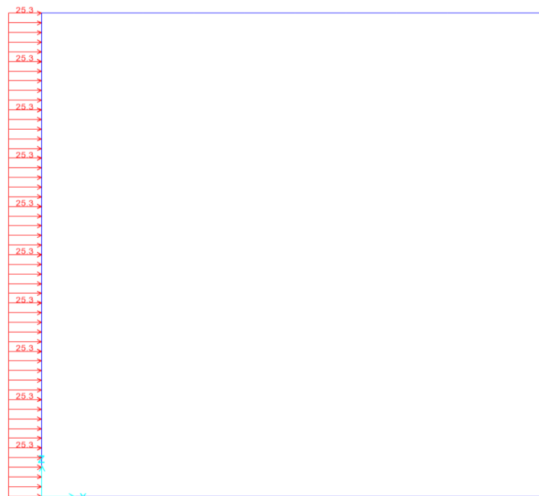
Figura 10.7 - condizione di carico Wood – sovrappinta sismica del terreno
