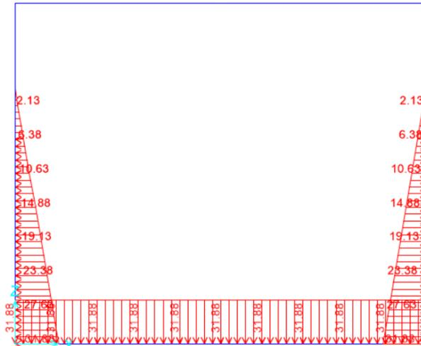
Figura 10.3 - condizione di carico  $u$  – spinta statica dell’acqua nella vasca
