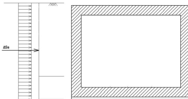
Fig. 8 – Schema per il calcolo degli effetti della sovrappinta sismica del terreno
