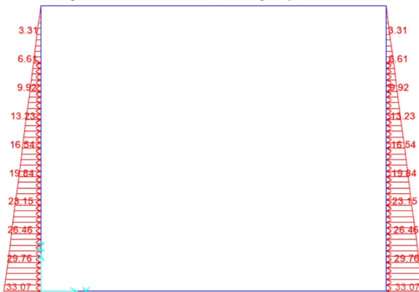
Figura 10.2 - condizione di carico g1 – spinta del terreno
