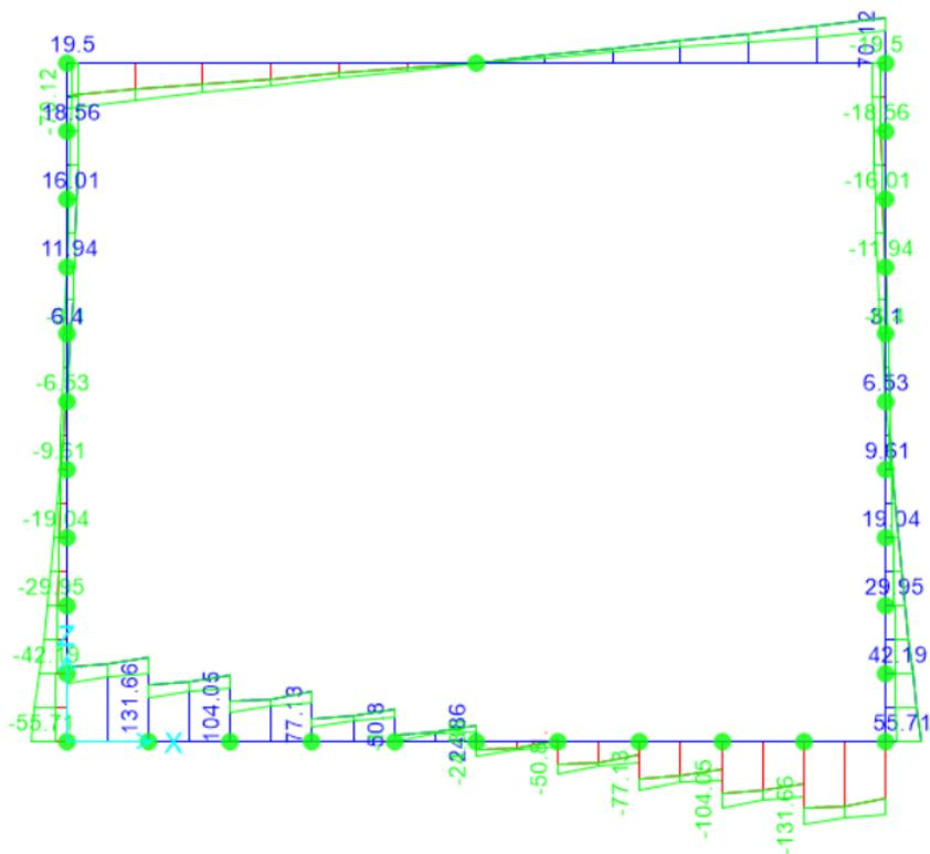
Figura 10.8 – Inviluppo SLE sforzo di taglio
