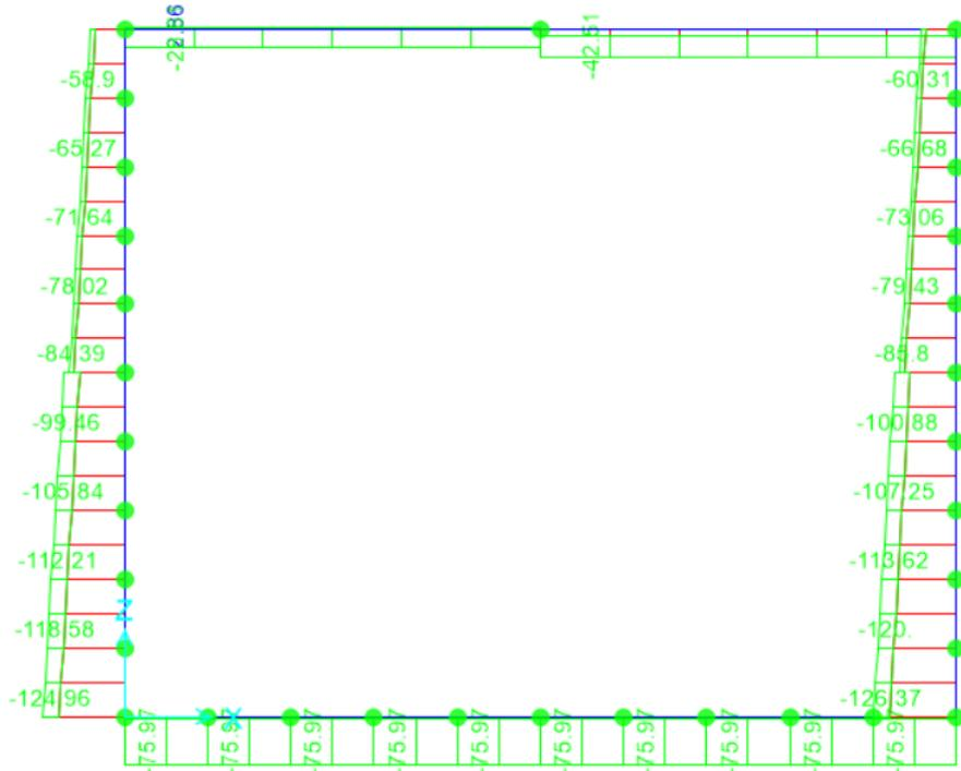
Figura 10.13 - Involuppo SLV sforzo normale
