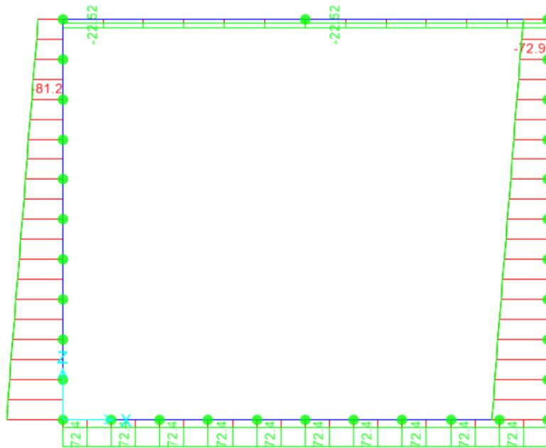
Figura 10.10 – Inviluppo SLU sforzo normale
