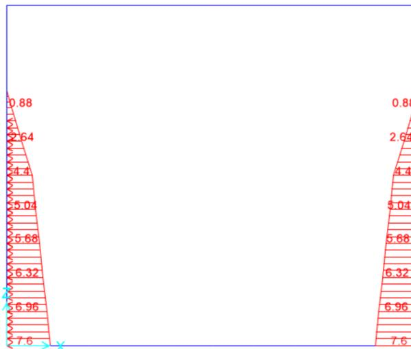
Figura 10.4 - condizione di carico  $u_{din}$  – spinta idrodinamica dell’acqua nella vasca
