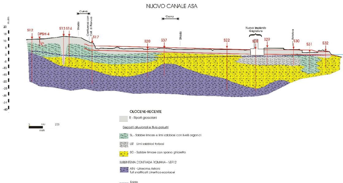
Figura 5.9 – stralcio del profilo geotecnico di progetto con ubicazione indicativa dell’opera oggetto di calcolo
