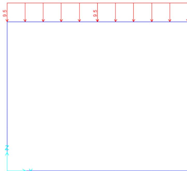
Figura 10.1 - condizione di carico g2 – peso rinterro
