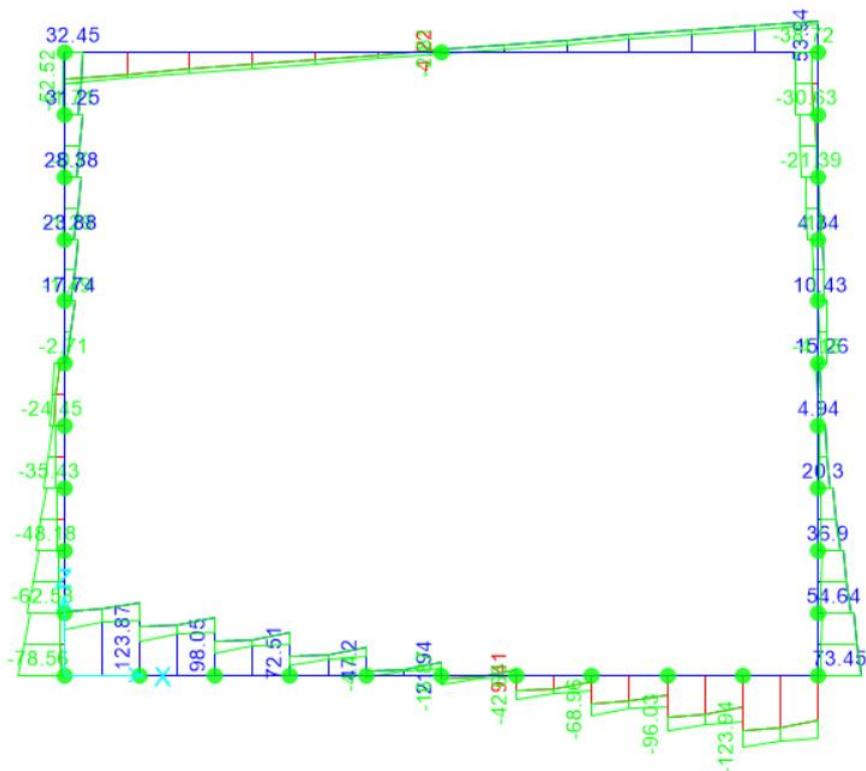
Figura 10.14 - Involuppo SLV sforzo di taglio
