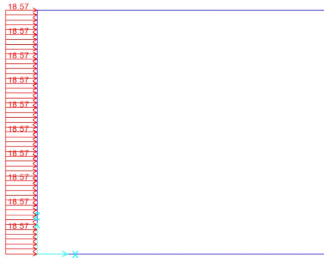
Figura 10.5 - condizione di carico Wood – sovrappinta sismica del terreno
