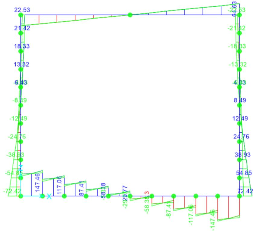
Figura 10.11 – Inviluppo SLU sforzo di taglio
