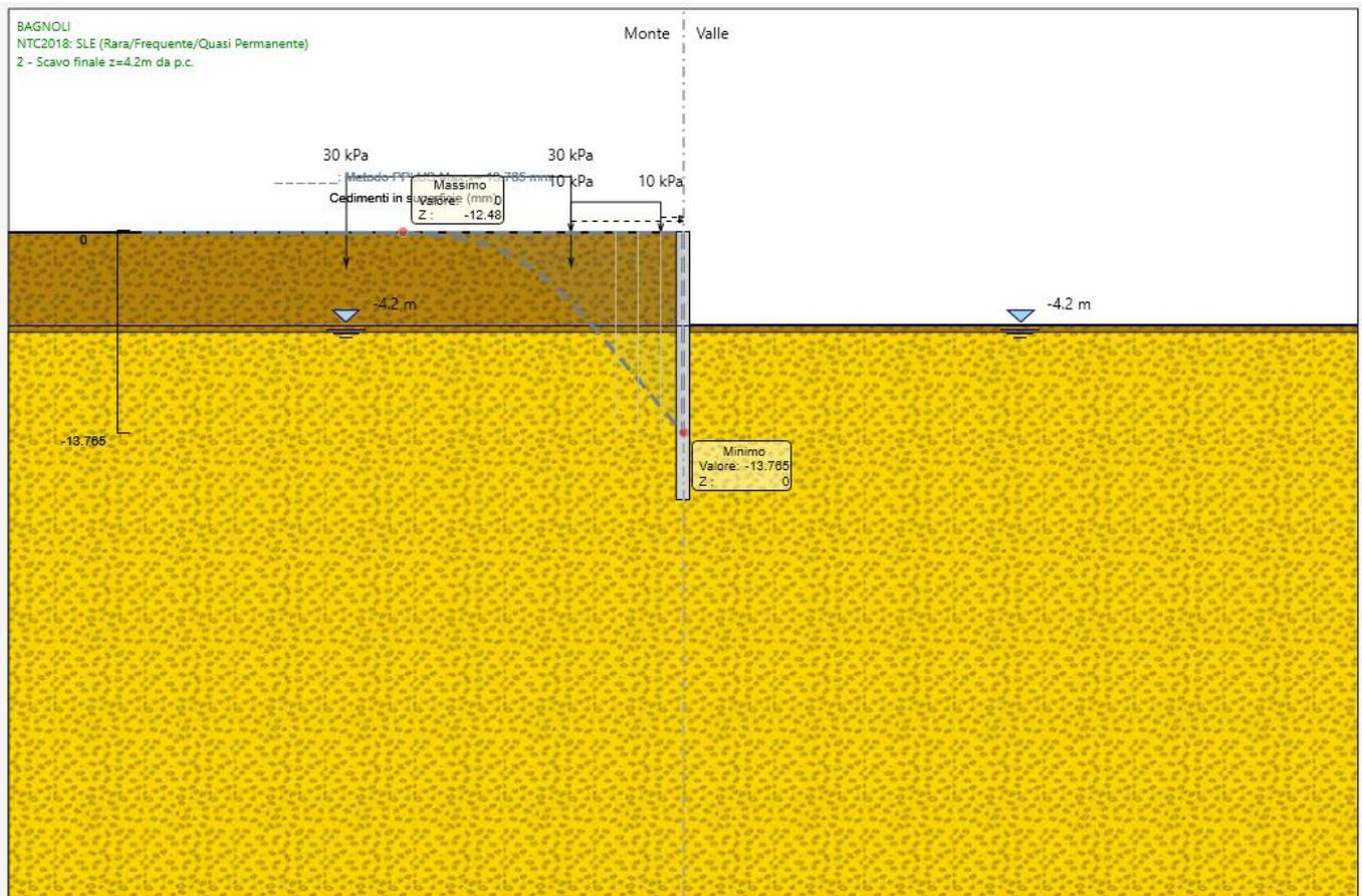
Figura 11: Cedimenti verticali del terreno calcolate mediante il metodo PPLUS.
