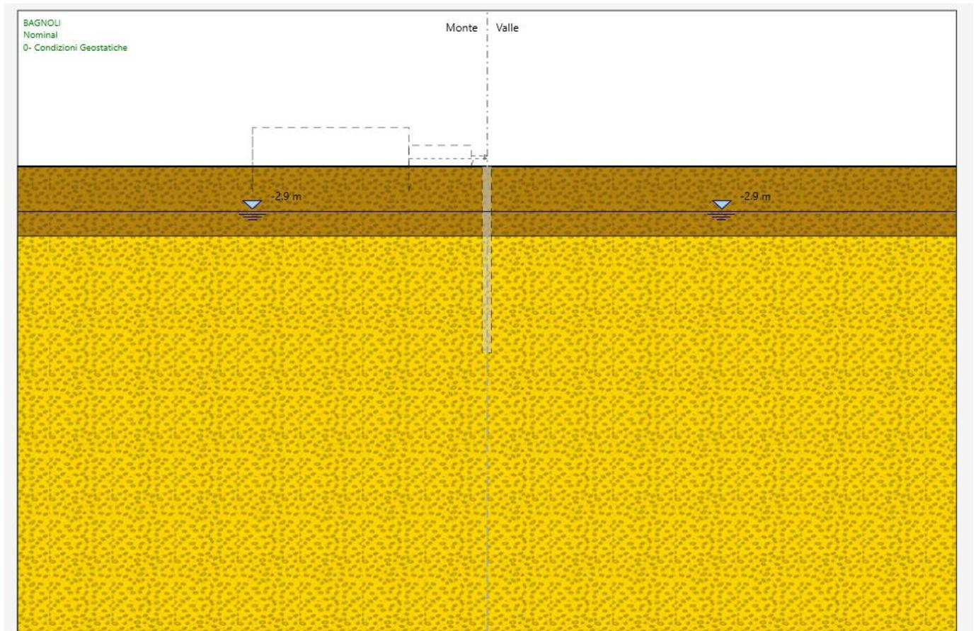
STEP 1): Realizzazione dei pali. A monte si considera il carico variabile da lavoro pari a 10 kPa e il carico permanente dovuto al peso dell’edificio pari a 30 kPa.
