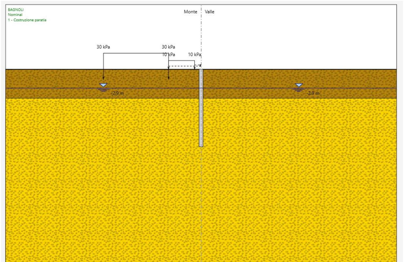
STEP 2): Scavo fino alla massima profondità di 4.2 m da testa palo. Il livello di falda viene portato a quota fondo scavo, ipotizzando che l’acqua dreni tra un palo e l’altro.
