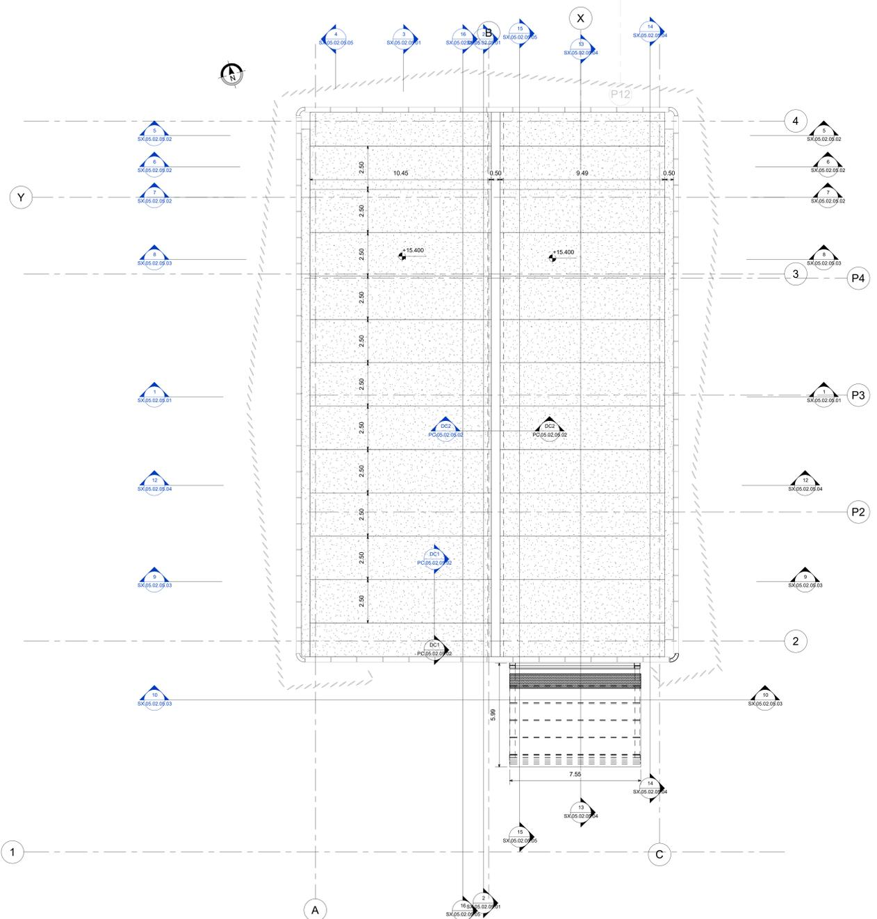
1 Pianta copertura travi prefabbricate
