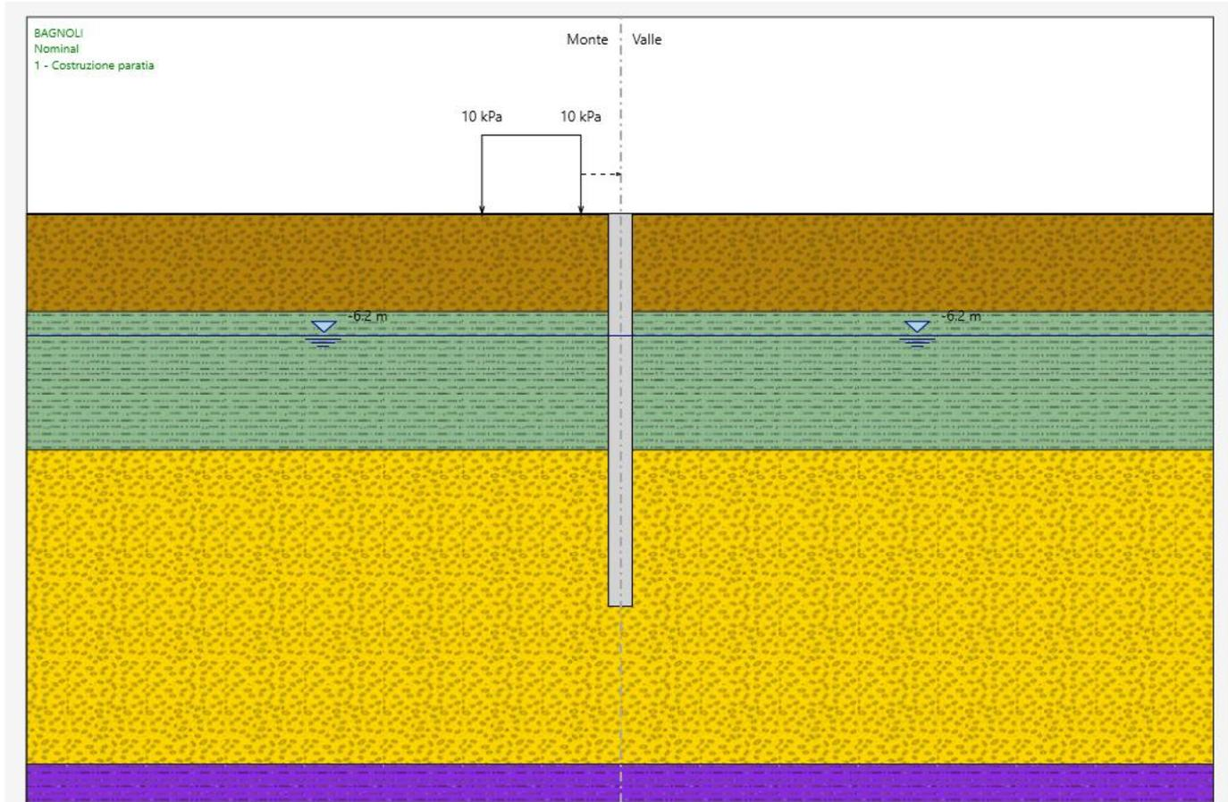
STEP 2): Scavo fino alla massima profondità di 7.4 m da testa palo. Il livello di falda viene portato a quota fondo scavo, ipotizzando che l’acqua dreni tra un palo e l’altro.
