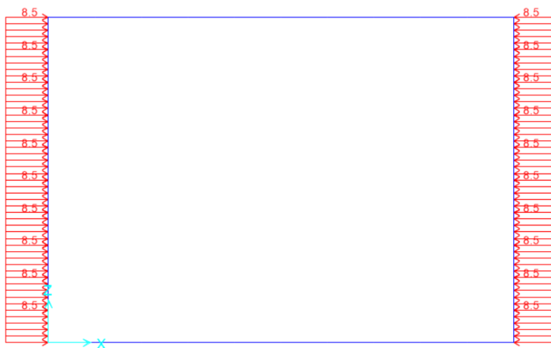
Figura 10.4 - condizione di carico q – spinta da sovraccarico
