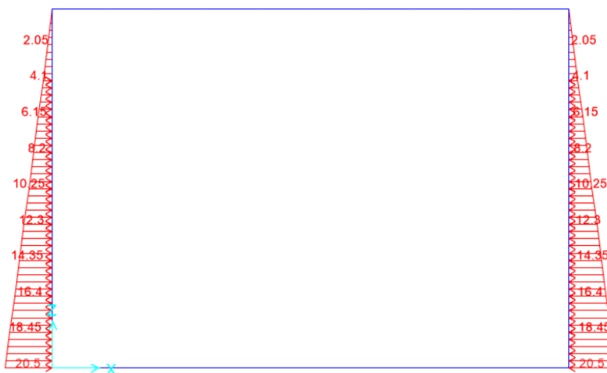
Figura 10.2 - condizione di carico g1 – spinta del terreno
