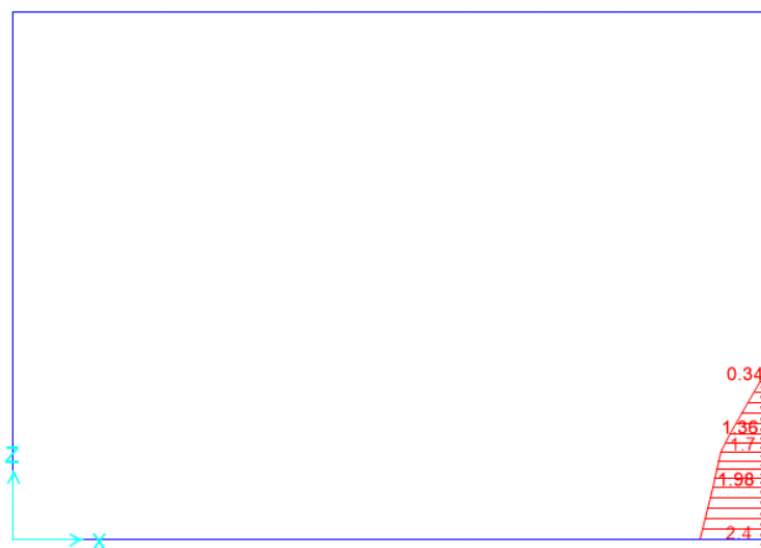
Figura 10.8 - condizione di carico S – spinta idrodinamica
