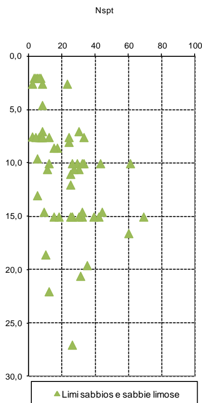
Figura 5.3 – valori penetrometrici SPT nei limi sabbiosi
