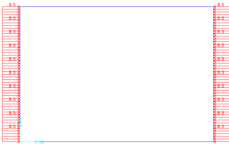
Figura 10.4 - condizione di carico q – spinta da sovraccarico
