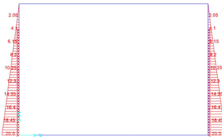
Figura 10.2 - condizione di carico g1 – spinta del terreno
