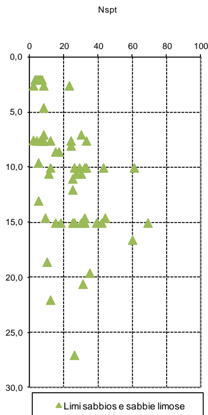
Figura 5.3 – valori penetrometrici SPT nei limi sabbiosi
