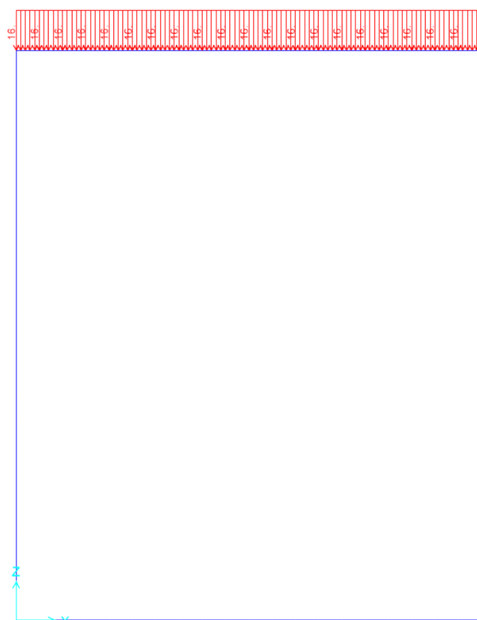
Figura 10.2 - condizione di carico g2 – peso rinterro
