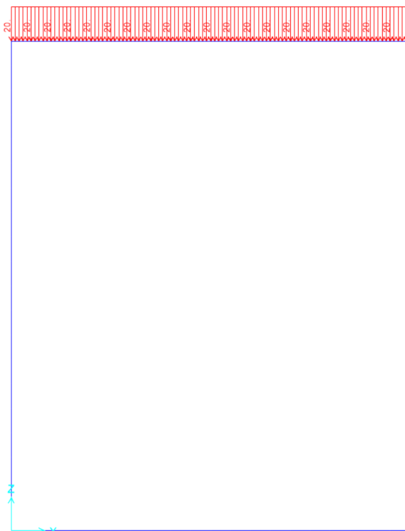
Figura 10.4 - condizione di carico q – sovraccarico stradale
