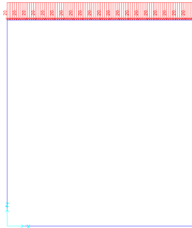
Figura 10.4 - condizione di carico q – sovraccarico stradale
