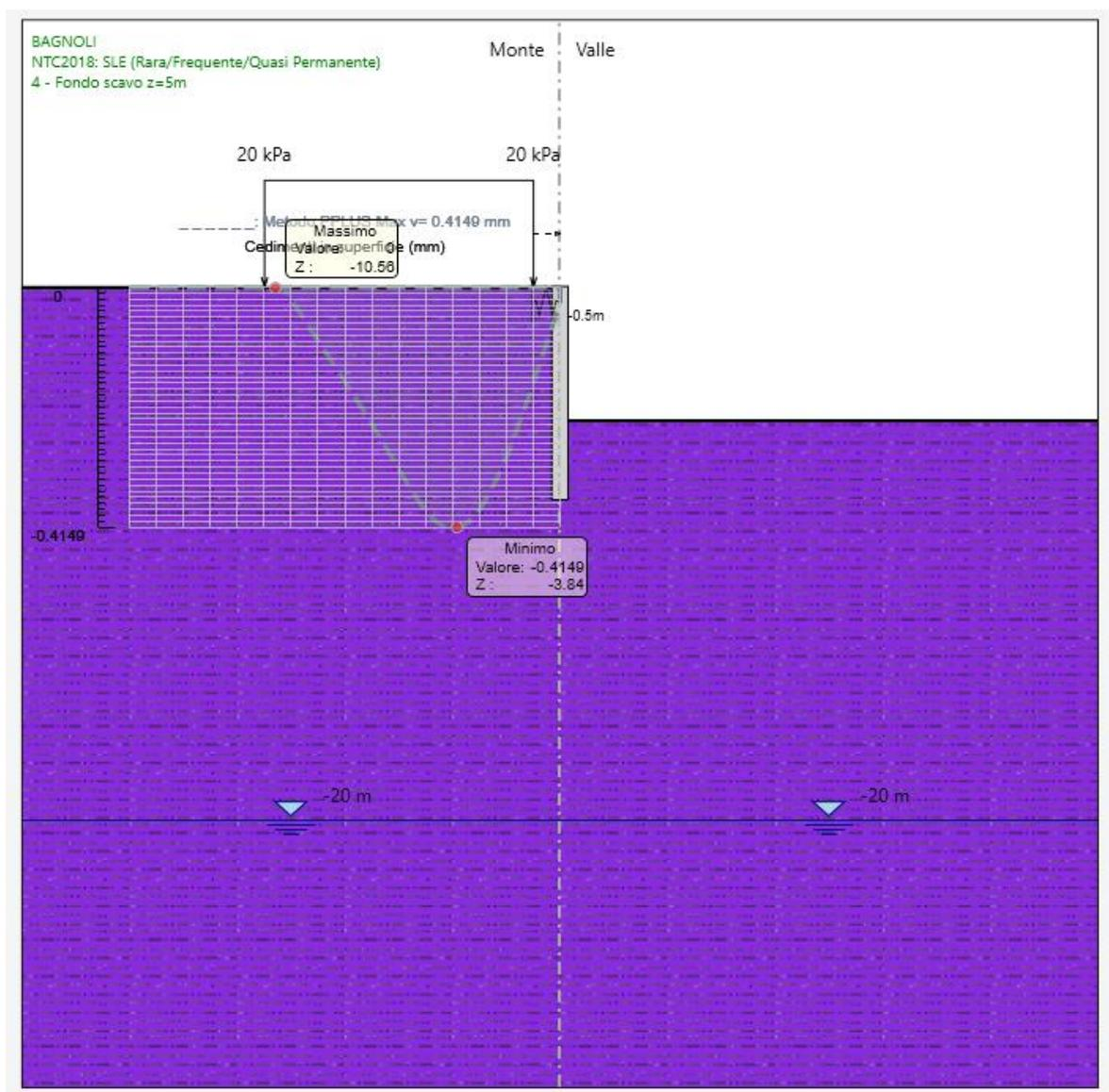
Figura 12: Cedimenti verticali del terreno calcolate mediante il metodo PPLUS.
