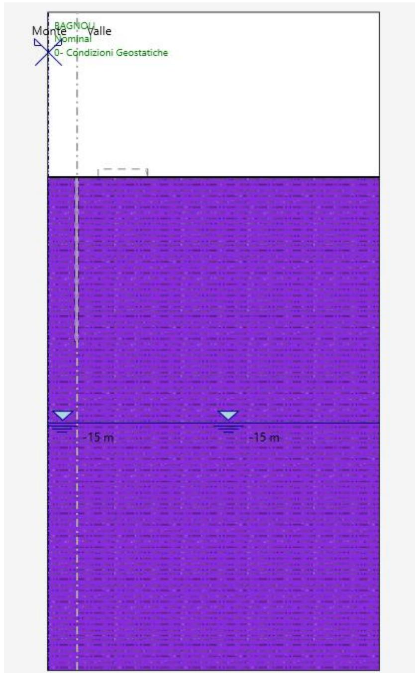
STEP 1) Realizzazione dei pali. A monte della paratia si considera il carico variabile dovuto ai mezzi pesanti da lavoro e sovraccarico permanente del terreno.
