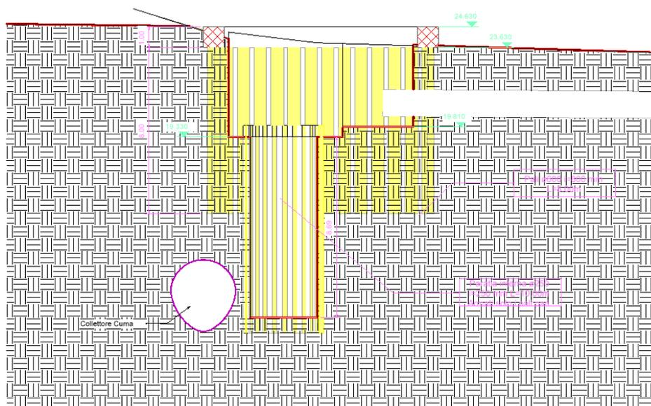
Figura 13: Sezione tipo – Opera provvisoria interna.
