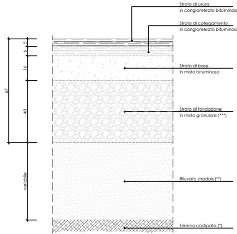
(\*) Fino ad assicurare alla prova con piastra Ø30 cm un modulo di compressibilità non minore di 15 kPa (150 kg/cmq)
