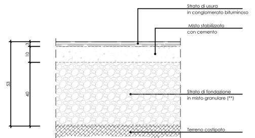
(\*\*) Da eseguire per strati di cm 20, compattati fino a dare un modulo di compressibilità non minore di 80 kPa (800 kg/cmq)
