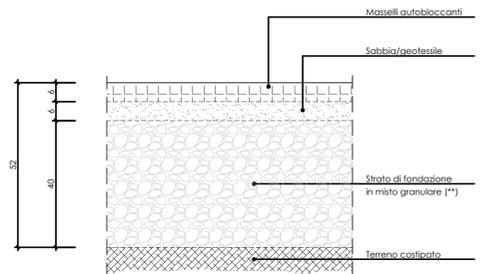
(\*\*) Da eseguire per strati di cm 20, compattati fino a dare un modulo di compressibilità non minore di 80 kPa (800 kg/cmq)
