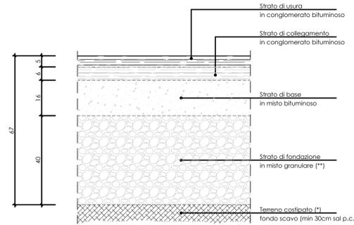
(\*) Fino ad assicurare alla prova con piastra Ø30 cm un modulo di compressibilità non minore di 15 kPa (150 kg/cmq)
