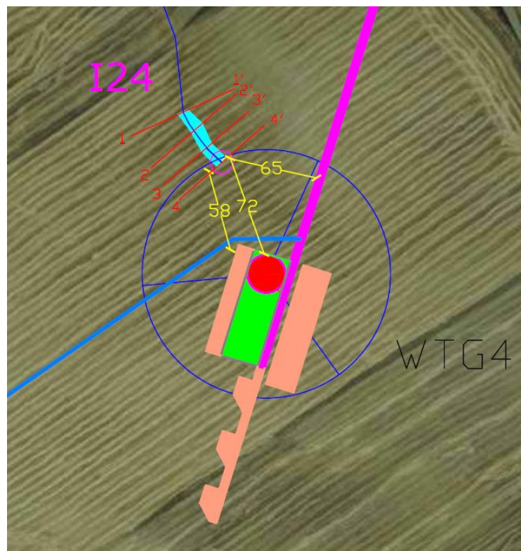
Figura 22 - individuazione parallelismo del reticolo idrografico con la piazzola e l'aerogeneratore WTG04 e individuazione dell'area allagabile determinata con T_r 200 anni
