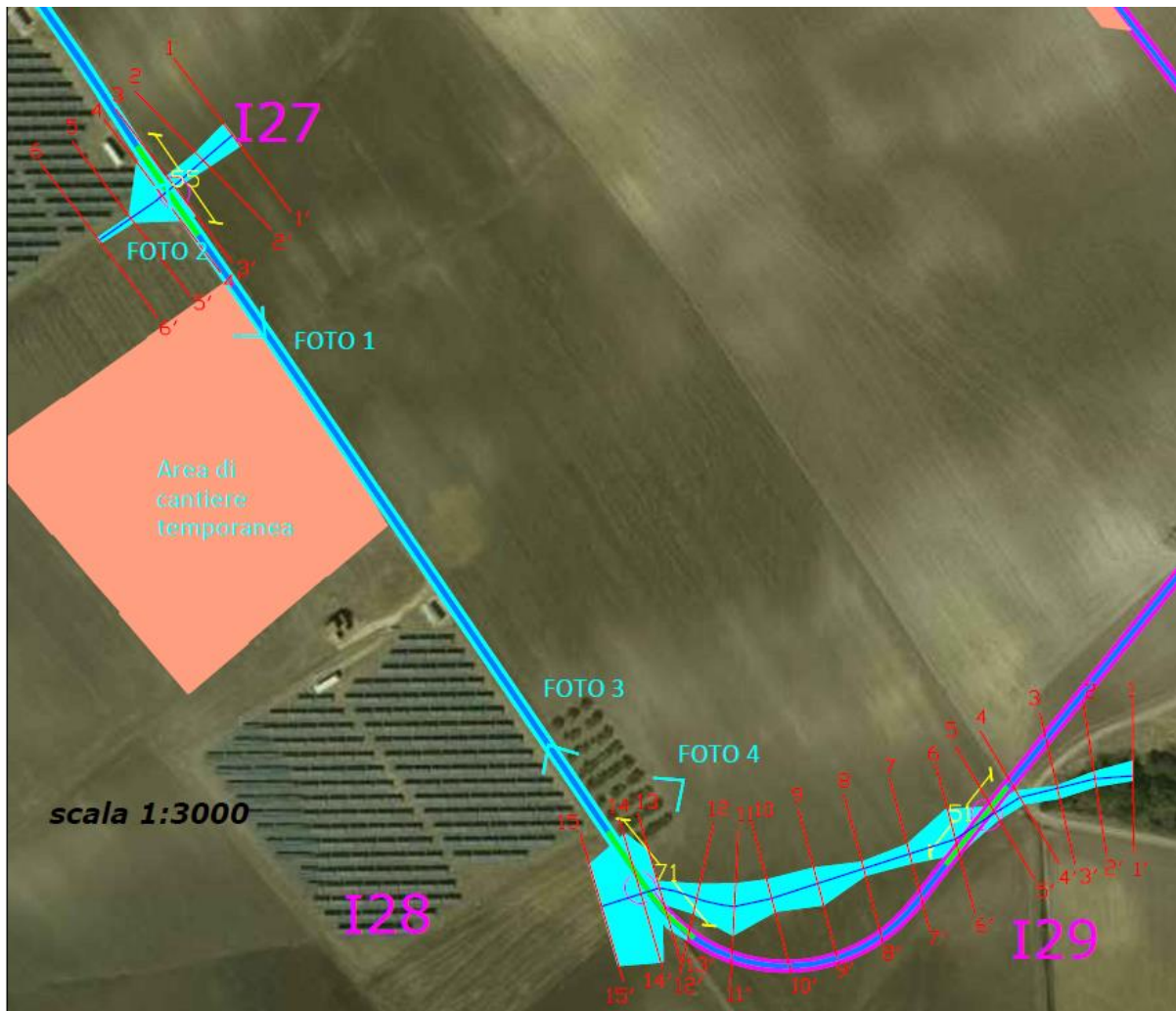
Figura 25 - individuazione dell'interferenza del reticolo idrografico con il cavidotto MT in ciano la strada esistente sulla quale non si eseguiranno opere e rappresentazione delle aree allagabili determinate con Tr200 anni. In verde il tratto di cavidotto da eseguire con TOC. In magenta la strada di nuova realizzazione.
