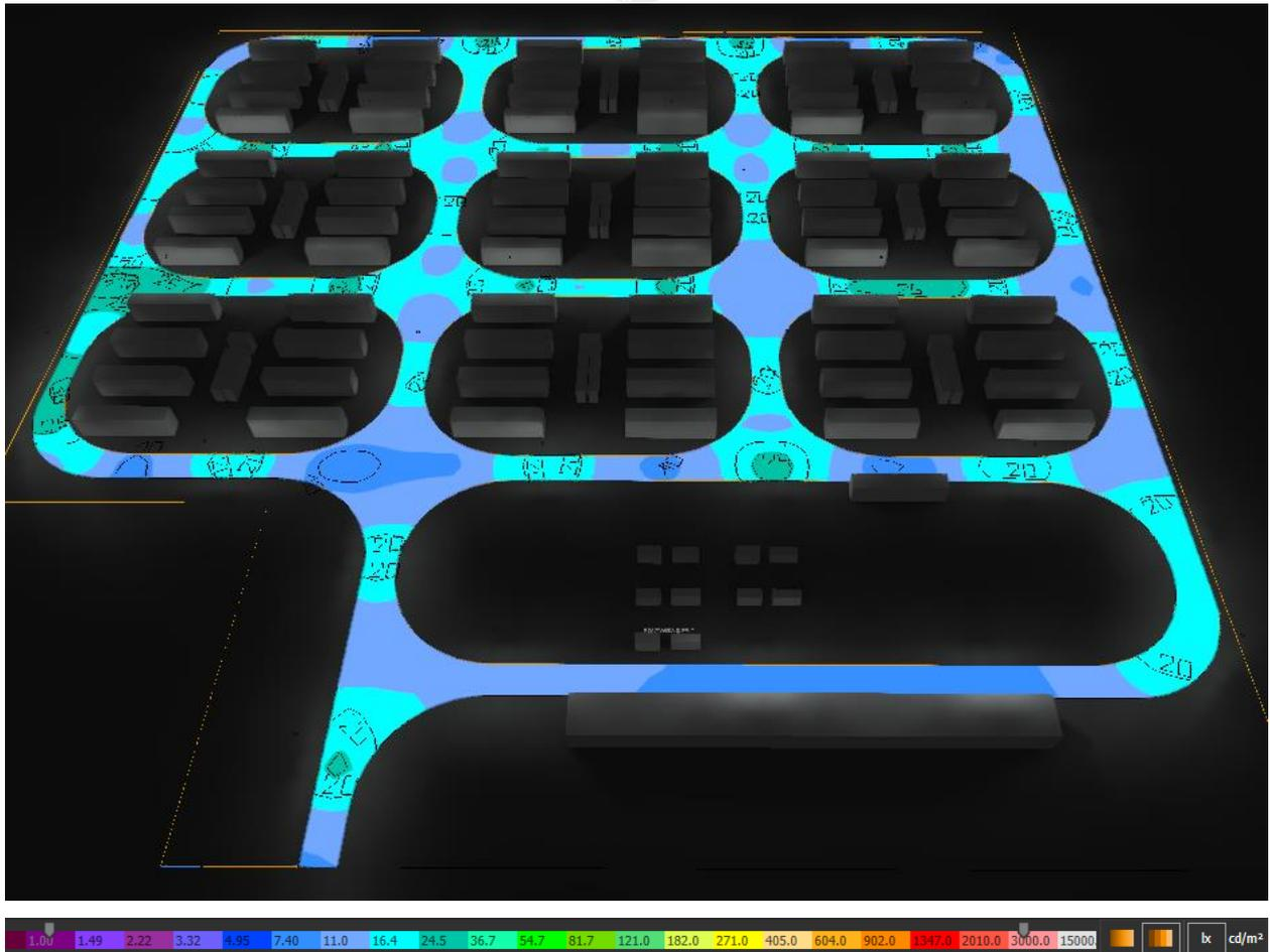
**Fig. 5 – Rappresentazione degli illuminamenti (lx) sulla viabilità tramite isolinee e colori sfalsati (vista laterale)**
