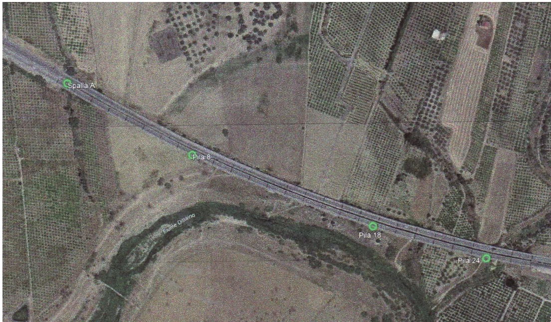
Figura 7.7 - Ubicazione dei sondaggi geognostici
