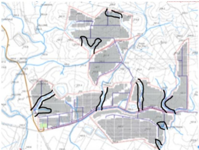
Figura 9: reticolo idrografico area , 2 3 ,4 e 5 8 RS06AEG0001S con indicate le aree da lasciare libere dai pannelli prossime ai reticoli presenti per una distanza 10m di lato
