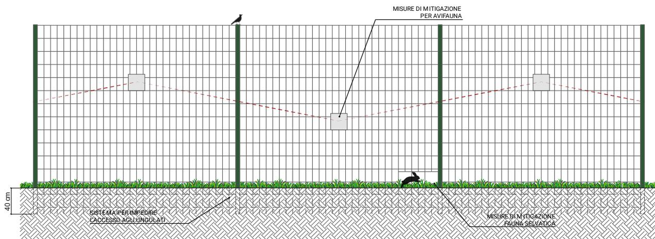
FIGURA 61 – ESEMPIO RECINZIONE METALLICA CHE DELIMITA L'AREA DI PERTINENZA DELL'IMPIANTO
