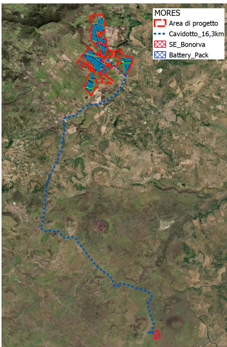
FIGURA 6 – INQUADRAMENTO GENERALE DELLE COMPONENTI DI PROGETTO CON LA LOCALIZZAZIONE DELLA SE (IMMAGINE AGGIORNATA)
