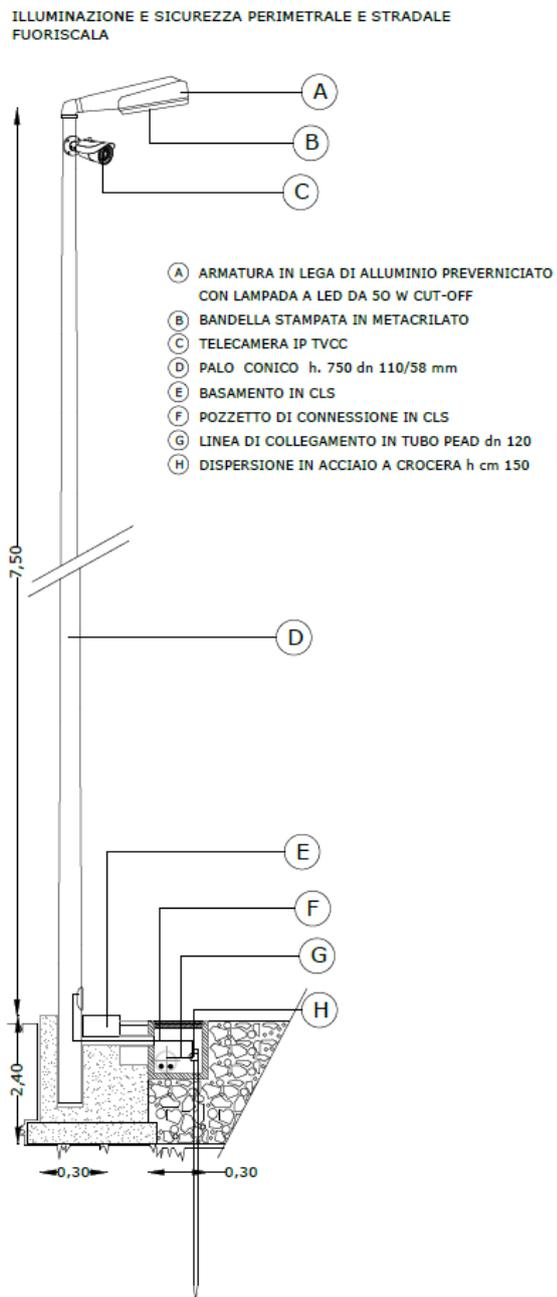
FIGURA 62 – ESEMPIO IMPIANTO DI ILLUMINAZIONE INTEGRATO CON SISTEMA DI VIDEOSORVEGLIANZA – ESTRATTO DALL'ELABORATO TECNICO MRS-PDR02
