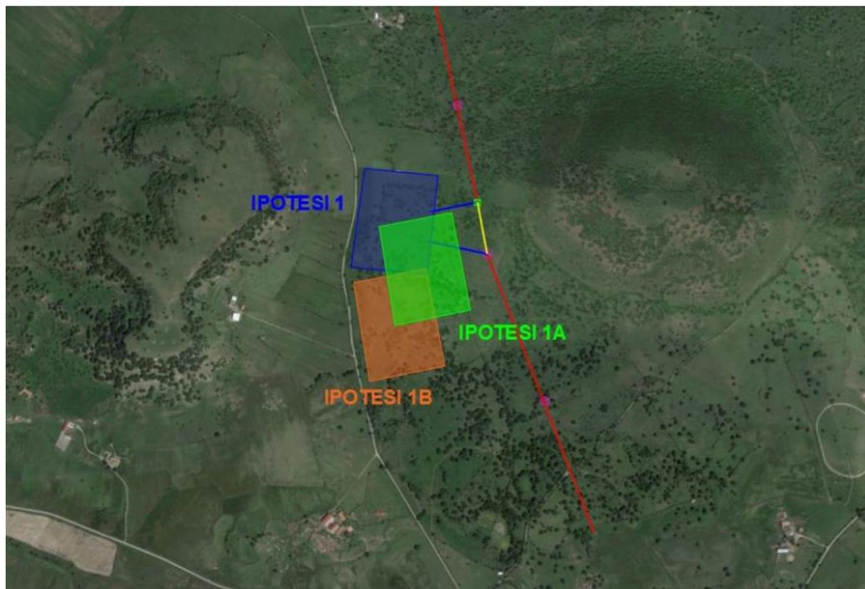
FIGURA 45 – INQUADRAMENTO SU ORTOFOTO DELLE 3 IPOTESI VALUTATE PER LA LOCALIZZAZIONE DELLA SE TERNA DI COLLEGAMENTO ALLA LINEA 220 kV DENOMINATA "CODRONGIANOS-OTTANA"
