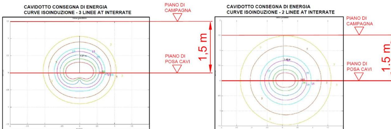
FIGURA 109 – CURVE ISOINDUZIONE PER I TRATTI ISOLATI DEI CAVIDOTTI DI MORES (A SX) E MORES 2 (A DX)
