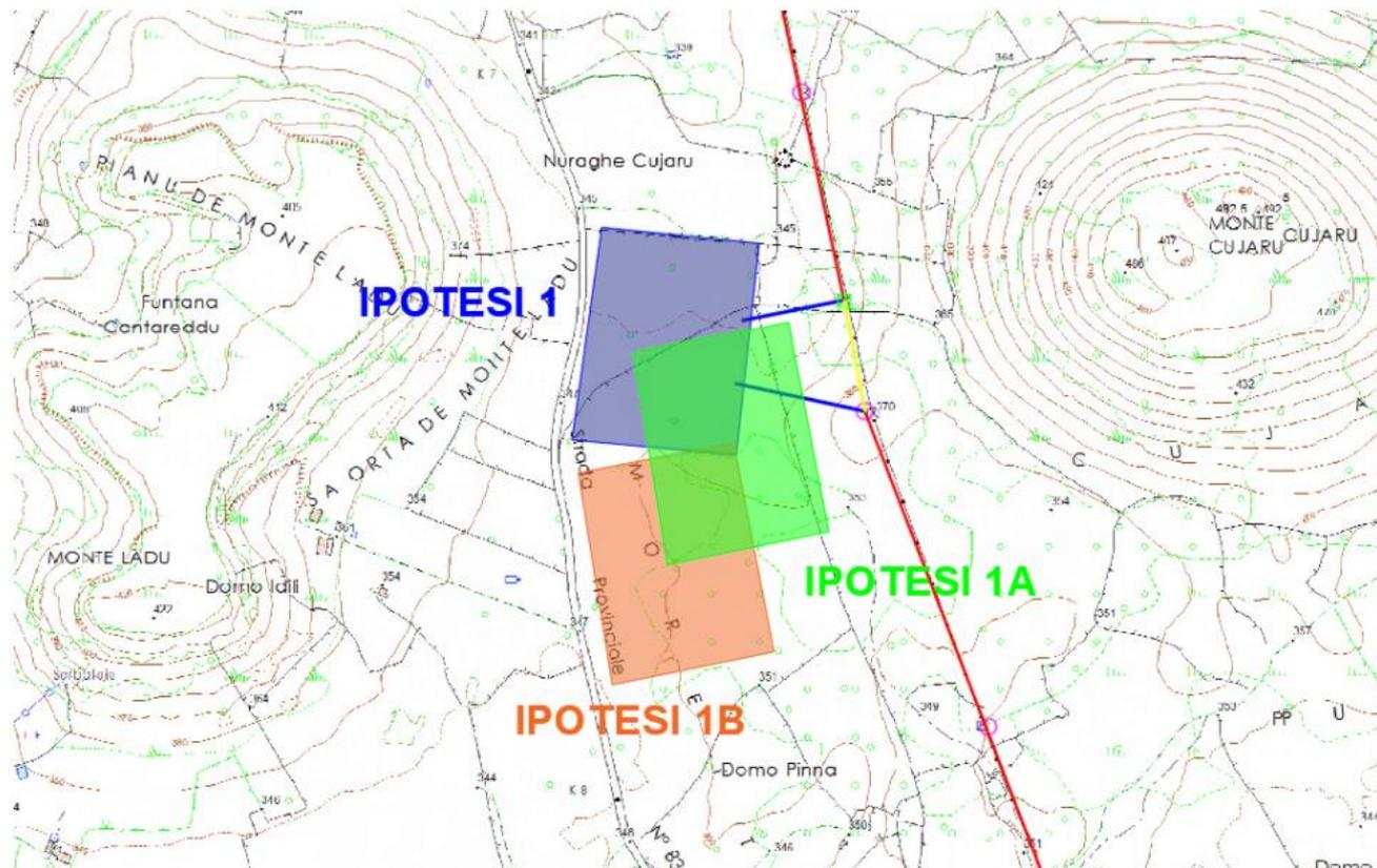
FIGURA 46 – INQUADRAMENTO SU CTR REGIONALE DELLE 3 IPOTESI VALUTATE PER LA LOCALIZZAZIONE DELLA SE TERNA DI COLLEGAMENTO ALLA LINEA 220 kV DENOMINATA "CODRONGIANOS-OTTANA"
