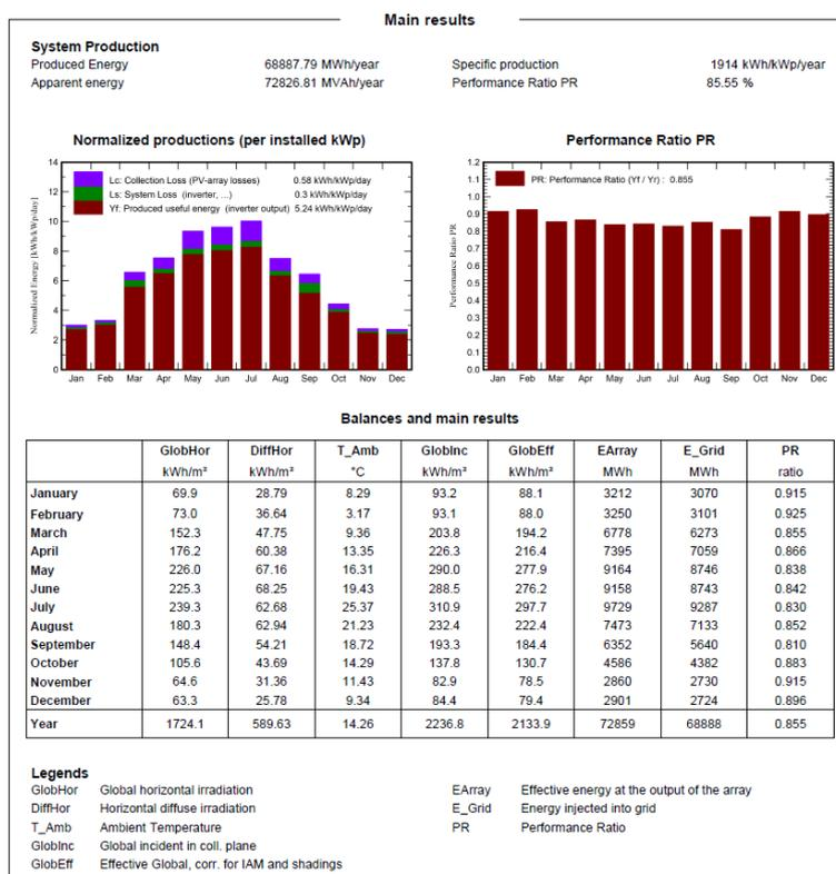
FIGURA 60 - PRODUCIBILITÀ ELETTRICA DELL'IMPIANTO AGRIVOLTAICO VALUTATA TRAMITE PVSYS
