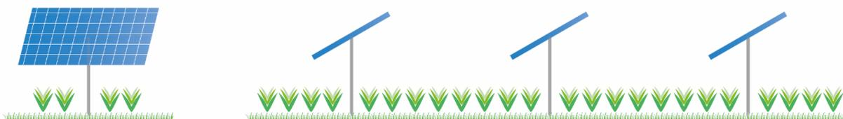
FIGURA 54 – TIPO 1) L'ALTEZZA MINIMA DEI MODULI È STUDIATA IN MODO DA CONSENTIRE LA CONTINUITÀ DELLE ATTIVITÀ AGRICOLE E ZOOTECNICHE ANCHE SOTTO AI MODULI FV.
