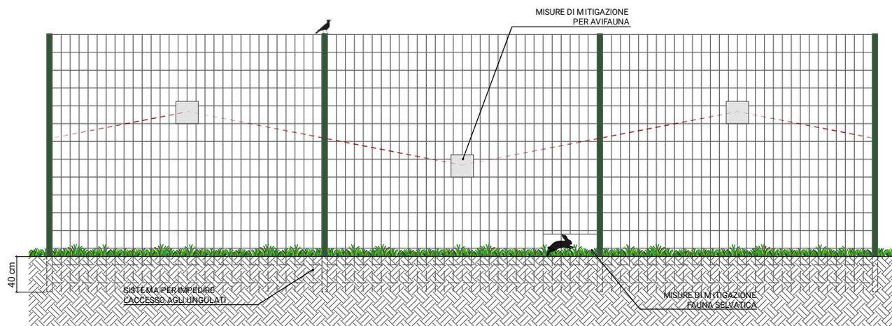
**FIGURA 148 - RECINZIONE METALLICA A DELIMITAZIONE DELL'AREA DI IMPIANTO**
