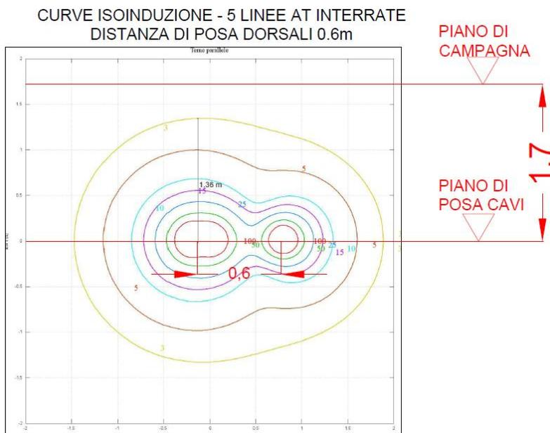
FIGURA 110 – CURVE ISOINDUZIONE NEL CASO DI 5 LINEE INTERRATE AT CON DISTANZA DI POSA DEI DUE ELETTRODOTTI PARI A 0,6 M
